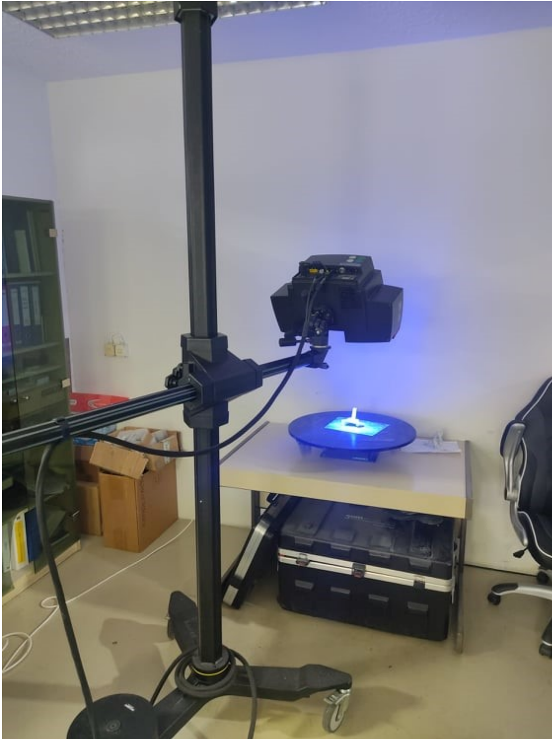
Slika 26. ATOS Triple Scan i plavo svjetlo
