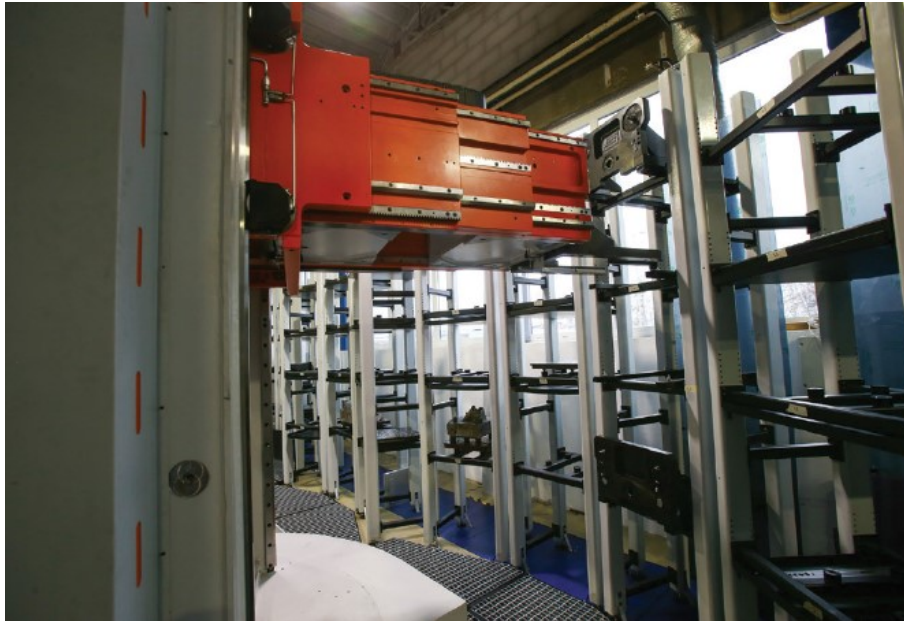
Slika 13. Izmjena prihvatnih vilica manipulatora [9]
