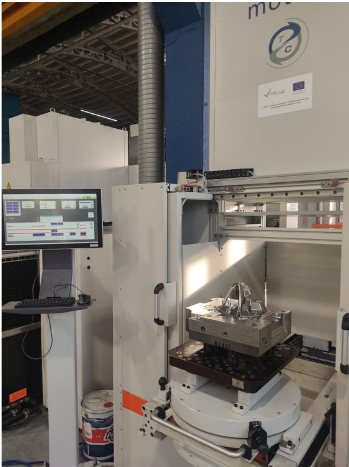
**Slika 48. Kalupni uložak na set up stationu**
