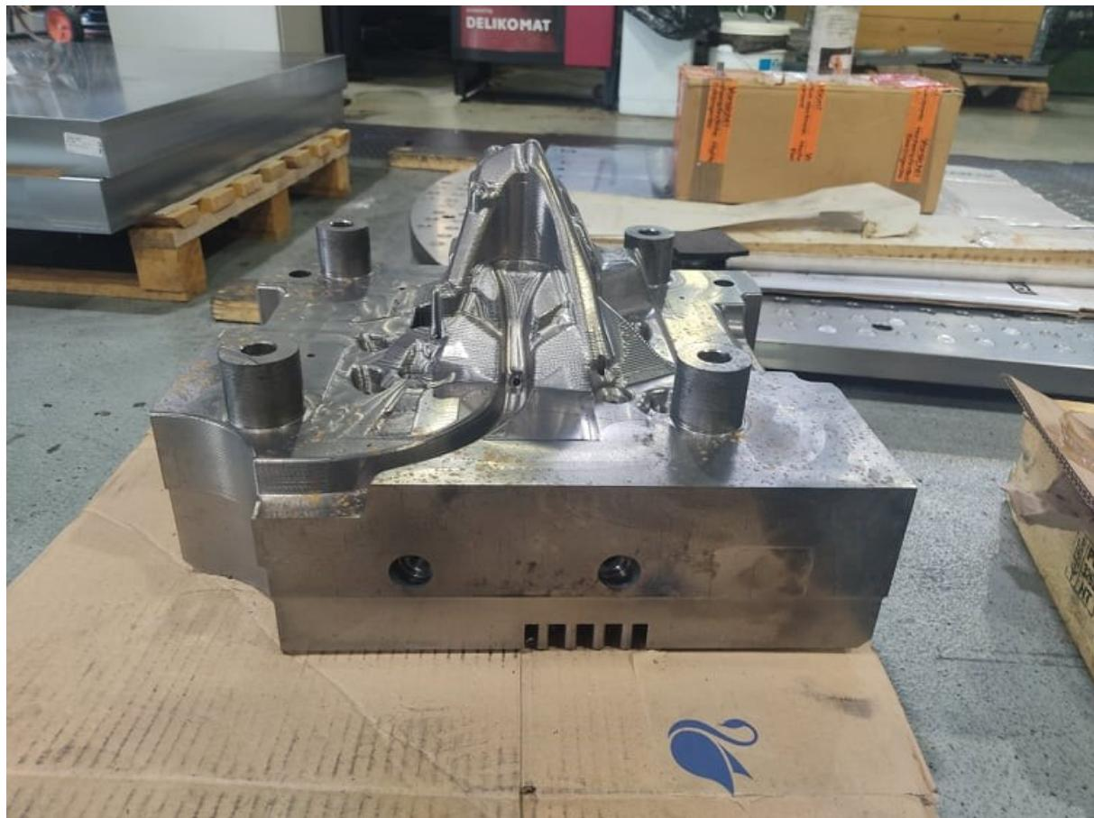
Slika 38. Obradak kalupnog uloška nakon termičke obrade
