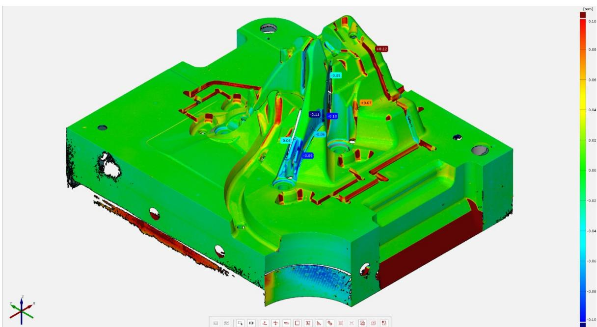
Slika 59. Usporedba 3D skena s 3D modelom
