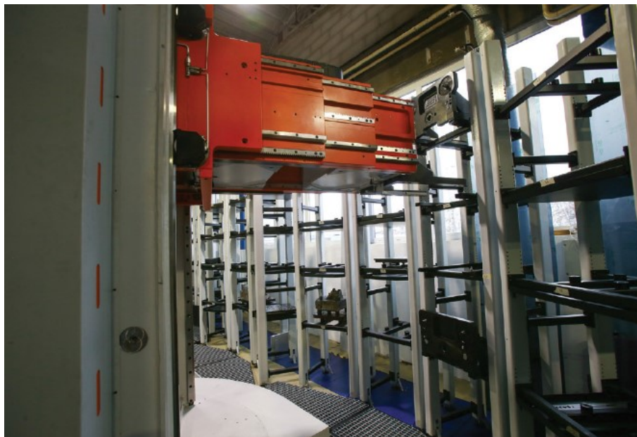
Slika 13. Izmjena prihvatnih vilica manipulatora [9]
