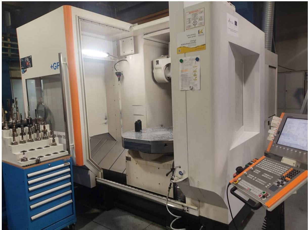
Slika 45. 5D vertikalna glodalica Mikron HPM 1350U
