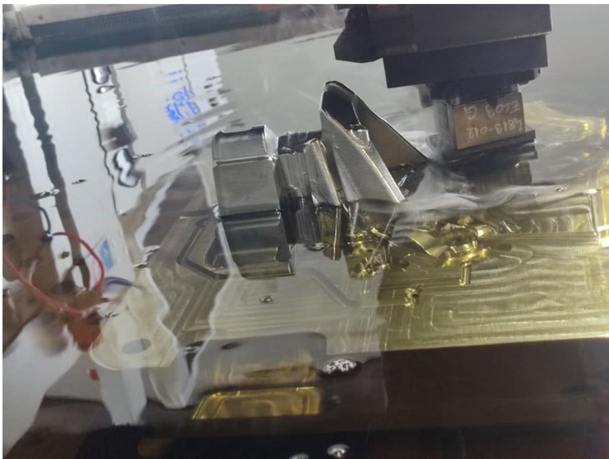
**Slika 55. Proces obrade kalupnog uloška**
