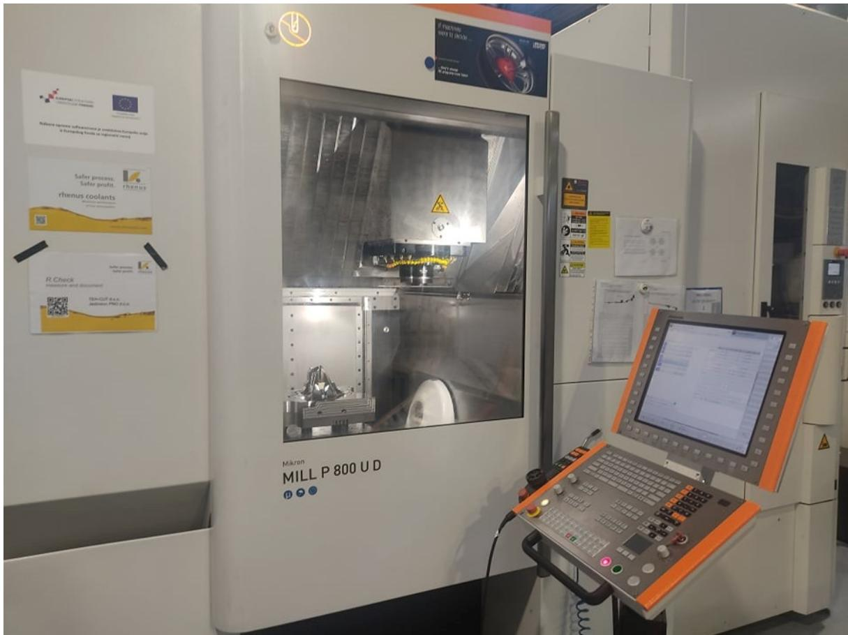
Slika 46. Mikron Mill P 800 UD stroj za strojnu obradu
