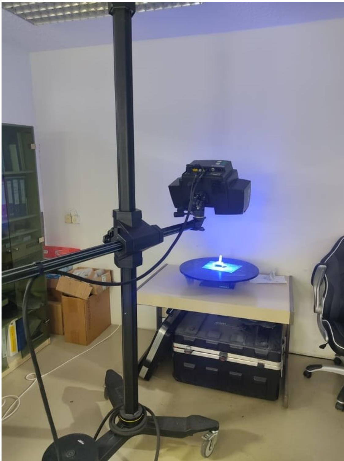
**Slika 26. ATOS Triple Scan i plavo svjetlo**
