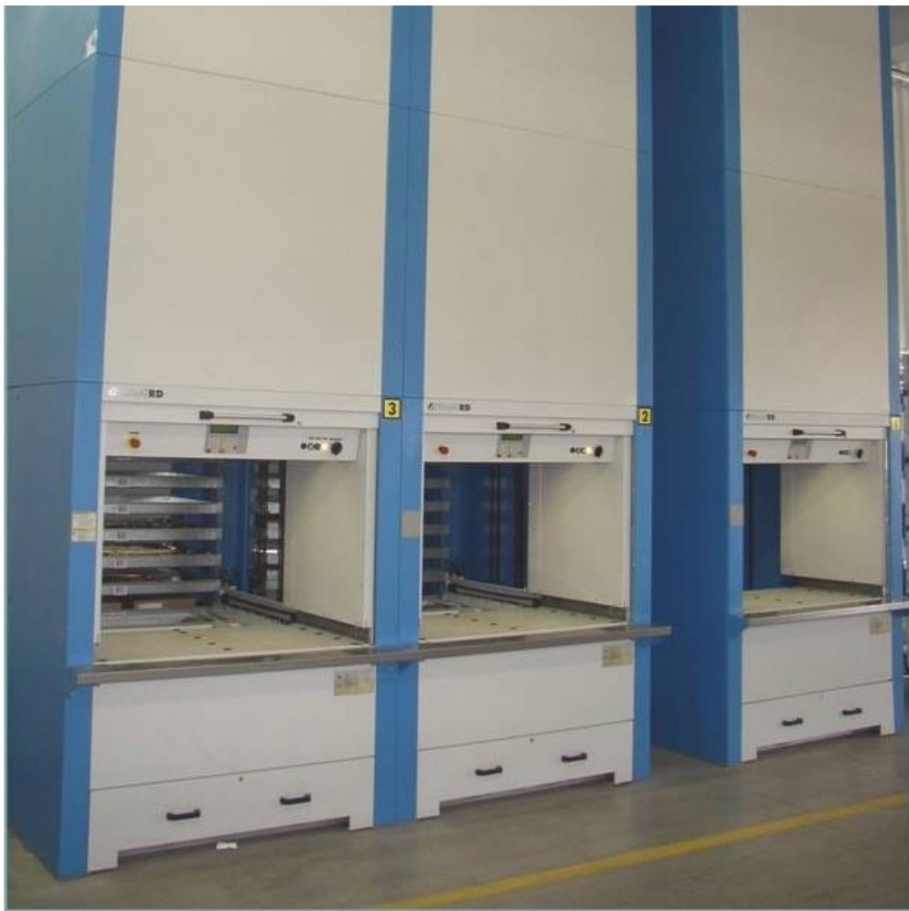
Slika 35. Vertikalni podizni moduli [21]
