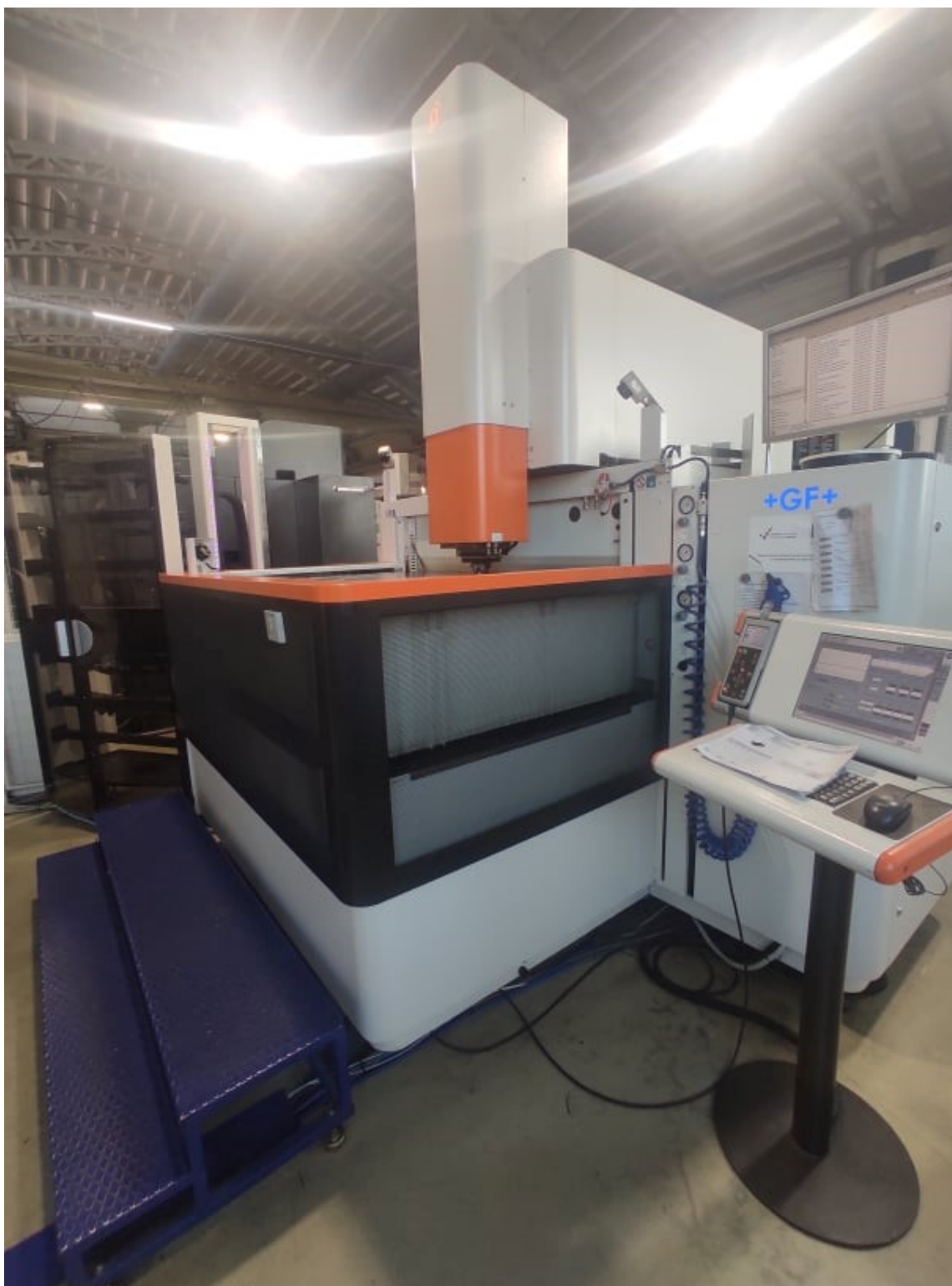
Slika 58. EDM Form P900 stroj
