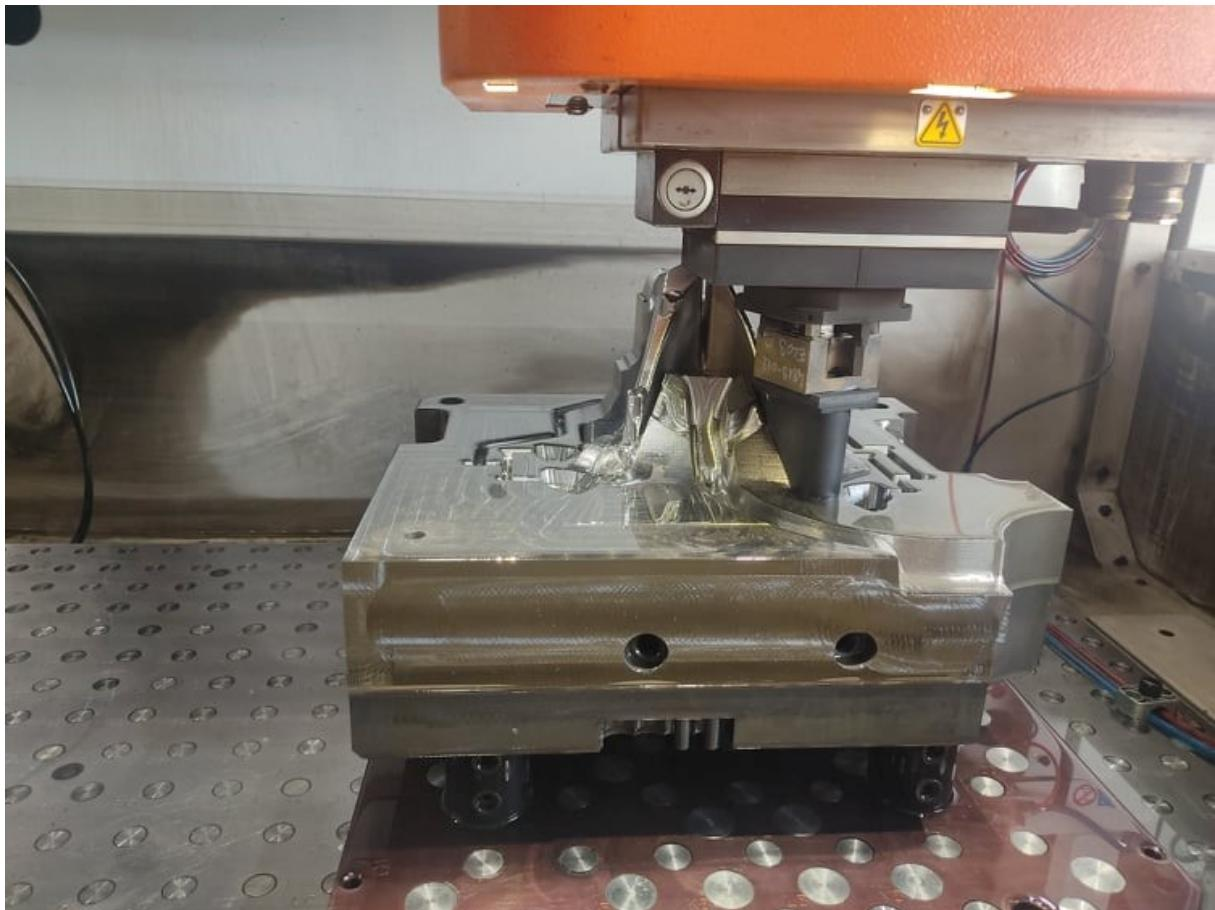
Slika 56. Izgled kalupnog uloška bez dielektrične tekućine
