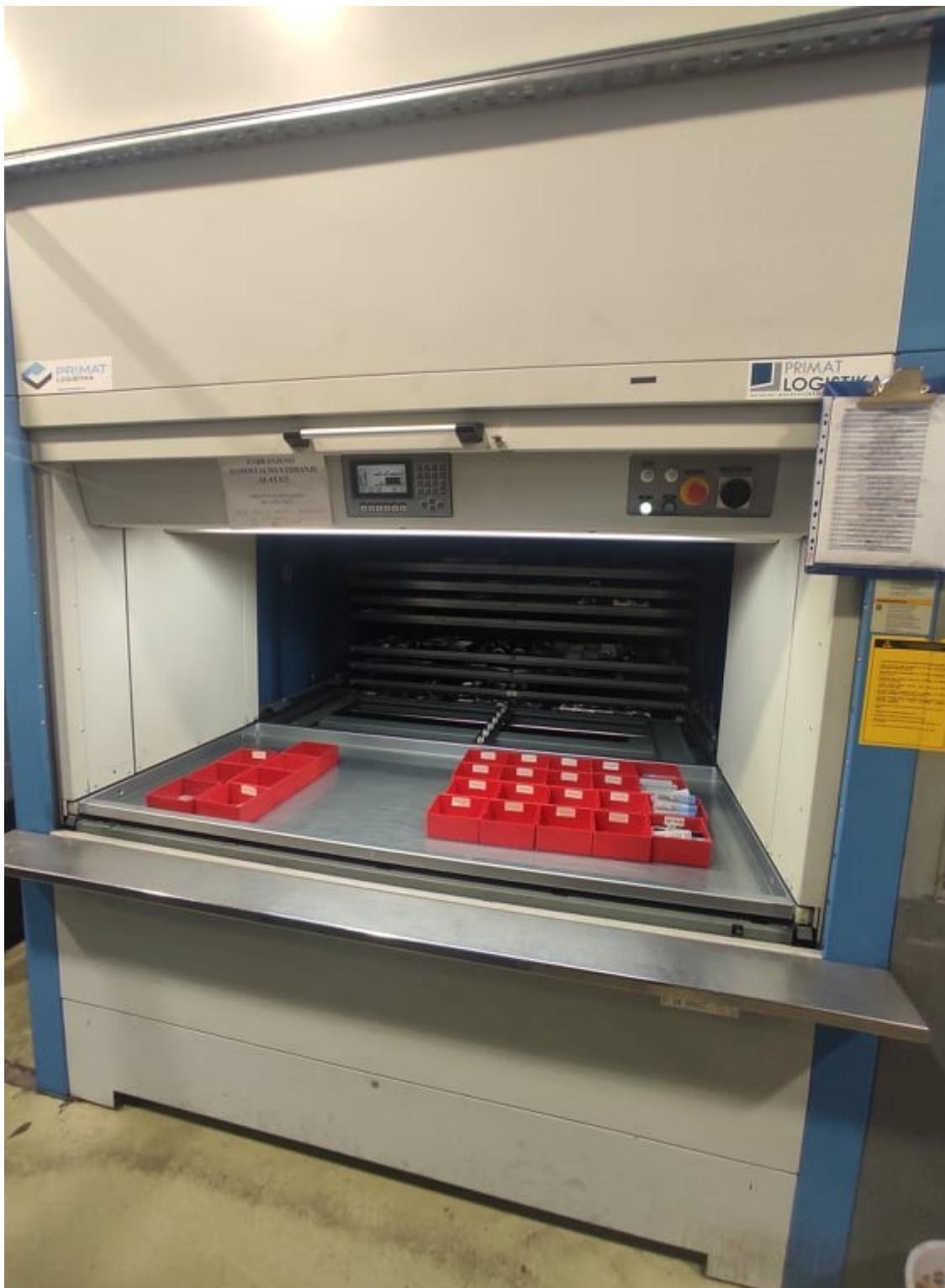
**Slika 49. Vertikalni podizni modul Kardex**
