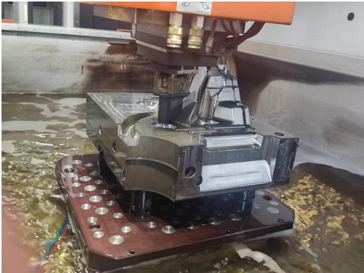
**Slika 57.** Izgled kalupnog uloška dok dielektrična tekućina istječe
