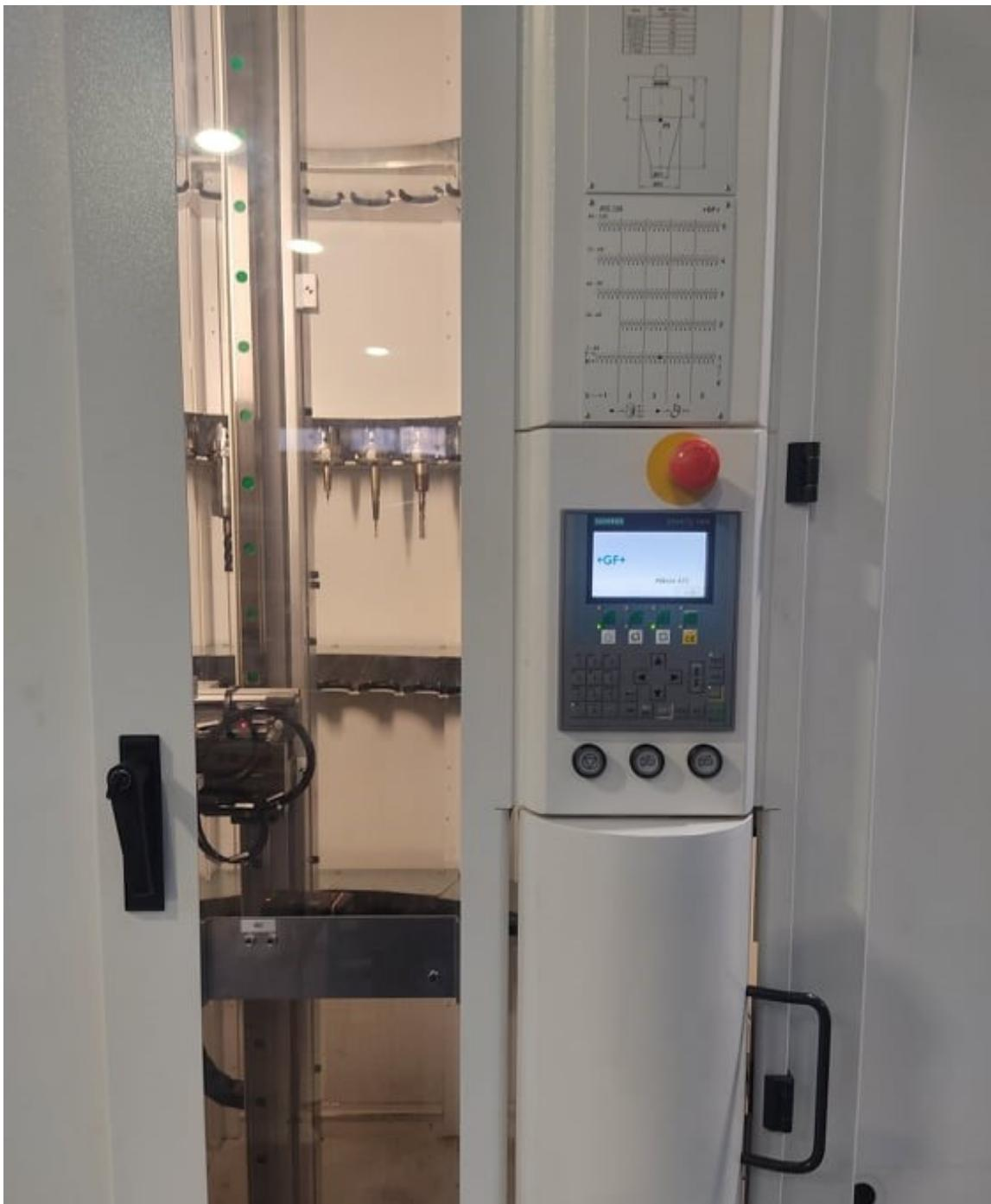
Slika 52. Magazin alata stroja Mikron Mill P800 UD
