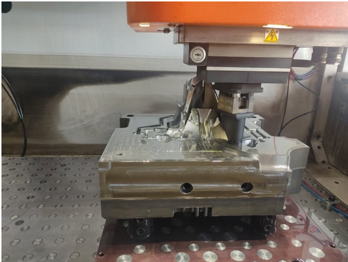
Slika 56. Izgled kalupnog uloška bez dielektrične tekućine
