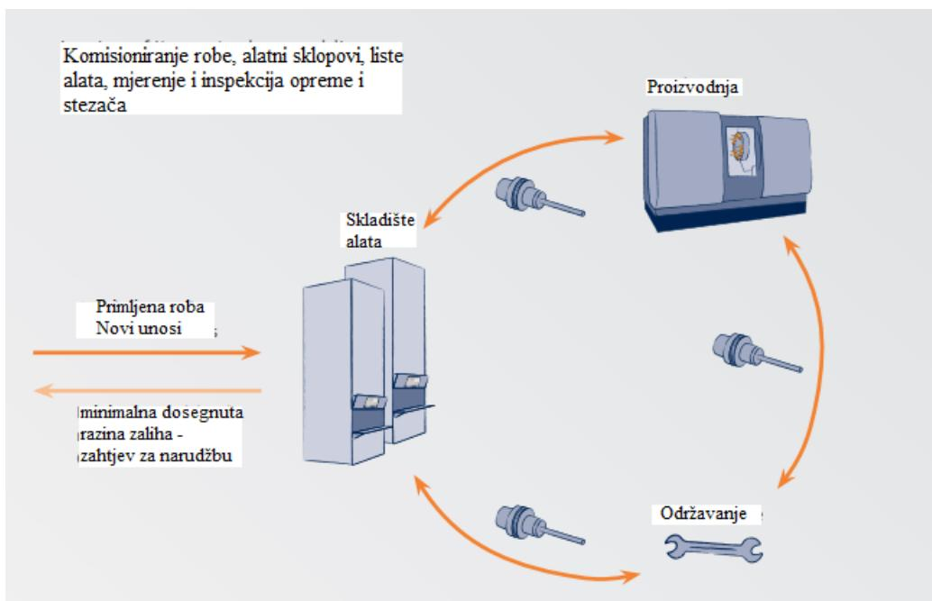
Slika 30. Prikaz sustava za upravljanje reznim alatima
