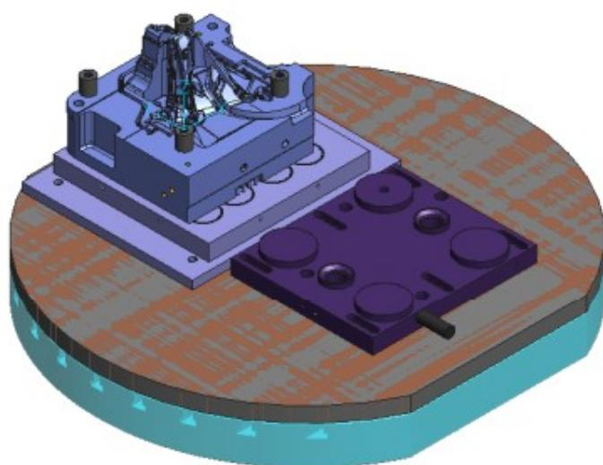
Slika 42. Stezanje obratka magnetom
