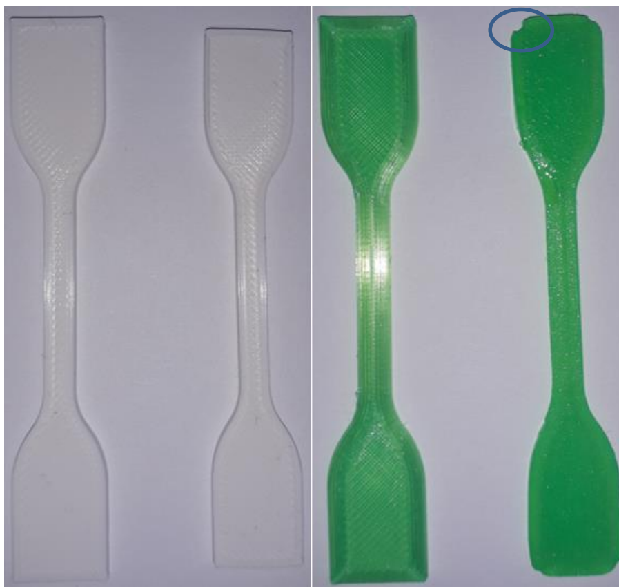
Slika 5.18. Epruvete žarene na 130°C
