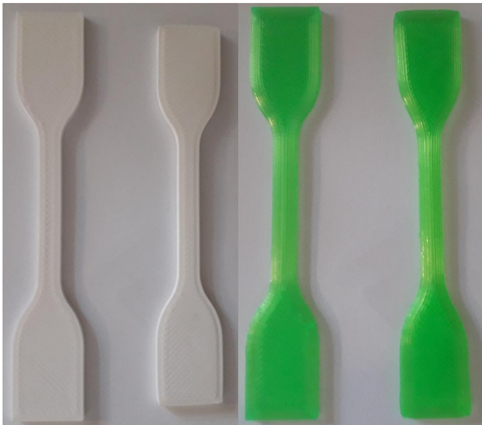
Slika 5.14. Epruvete žarene na 100°C
