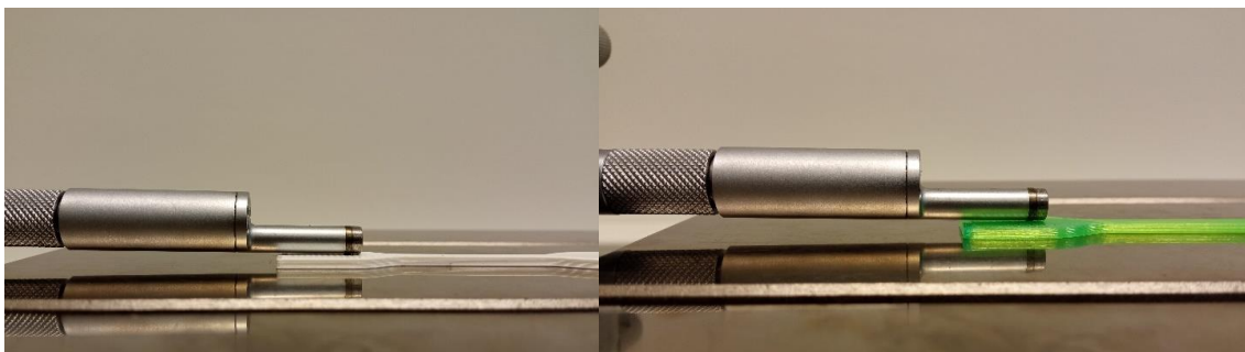
Slika 5.37. Mjerenje hrapavosti epruveta od PLA (lijevo) i PETG (desno)
