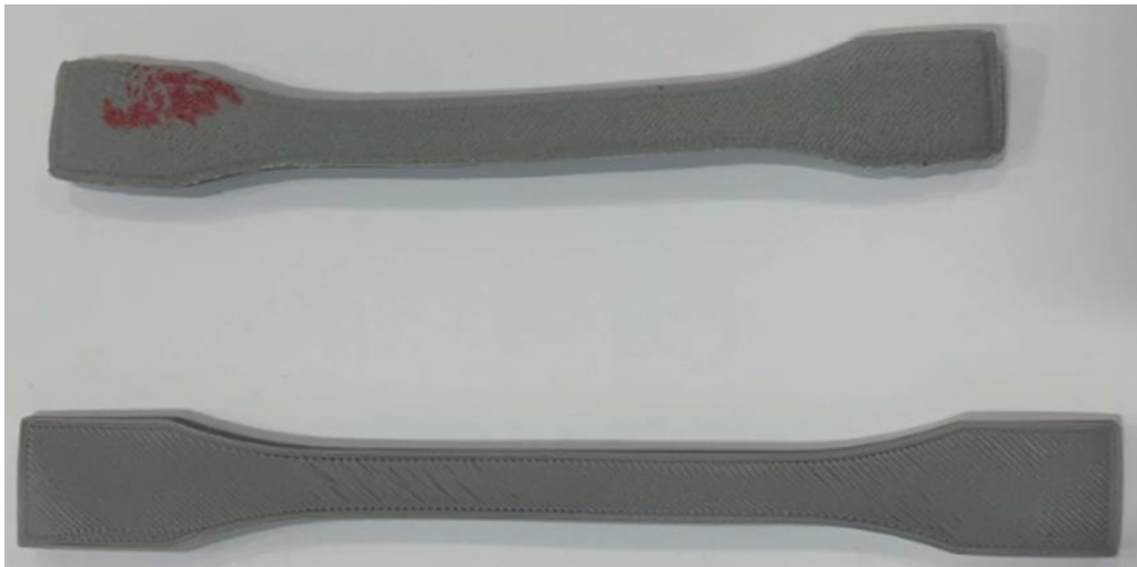
Slika 4.11. Deformacije ispitnog tijela od Al-ASA nakon žarenja [16]
