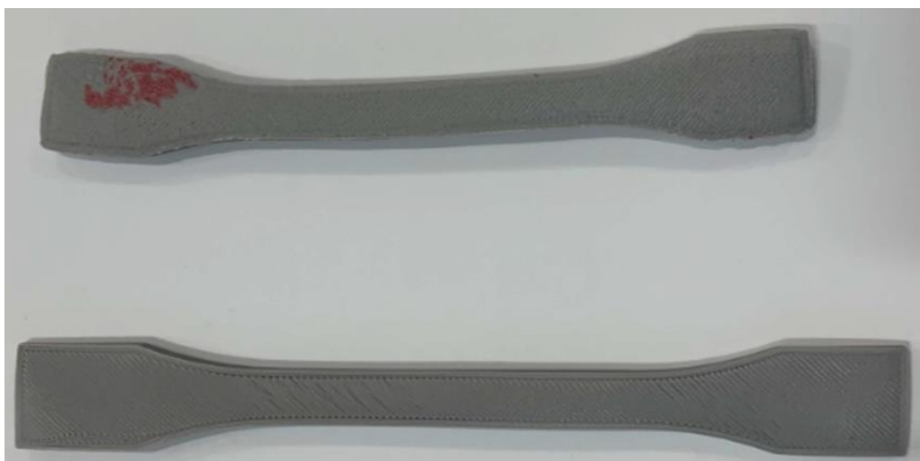
Slika 4.11. Deformacije ispitnog tijela od Al-ASA nakon žarenja [16]
