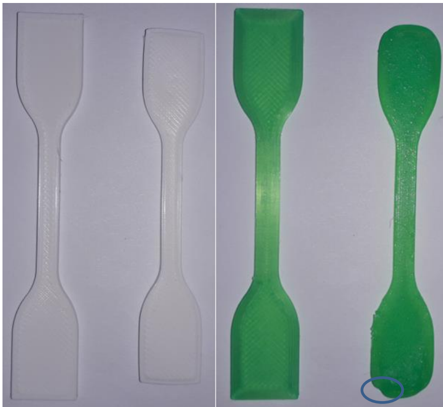
Slika 5.17. Epruvete žarene na 120°C
