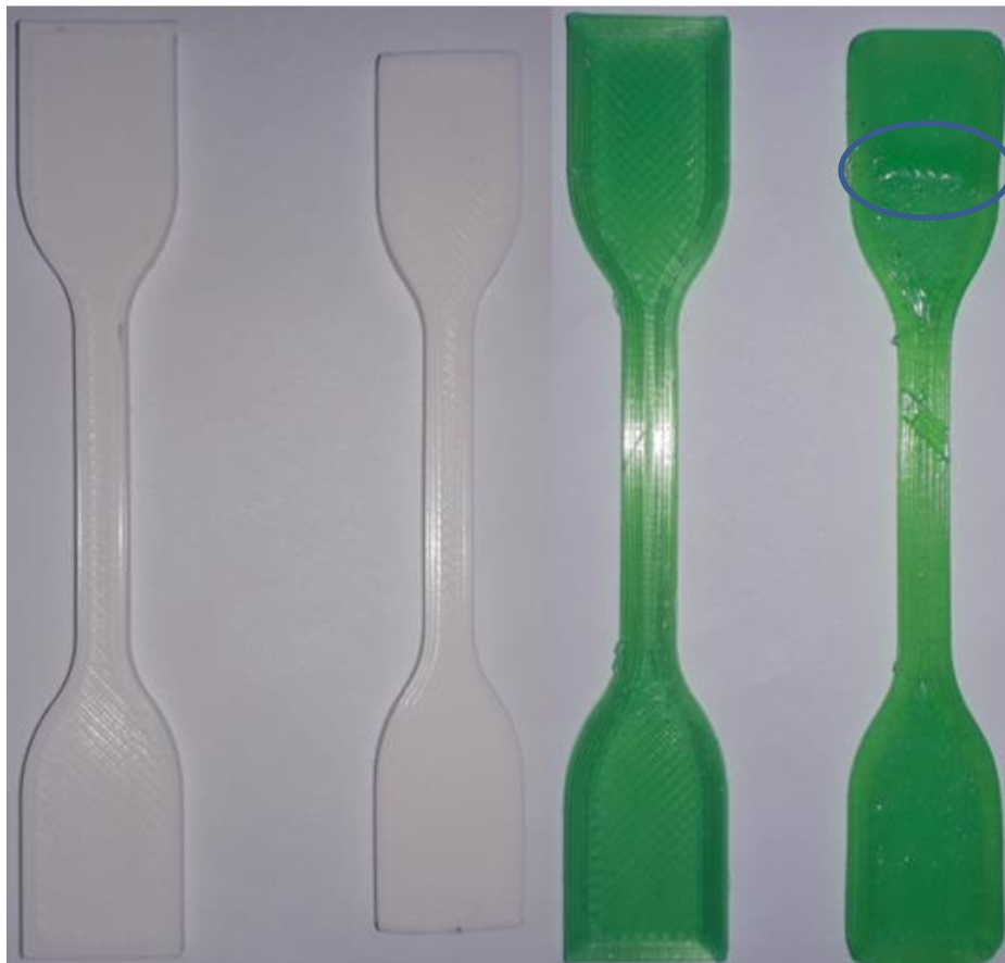
Slika 5.16. Epruvete žarene na 110°C
