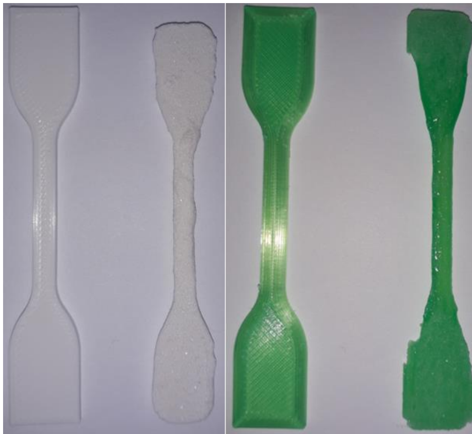
Slika 5.22. Epruvete žarene na 170°C
