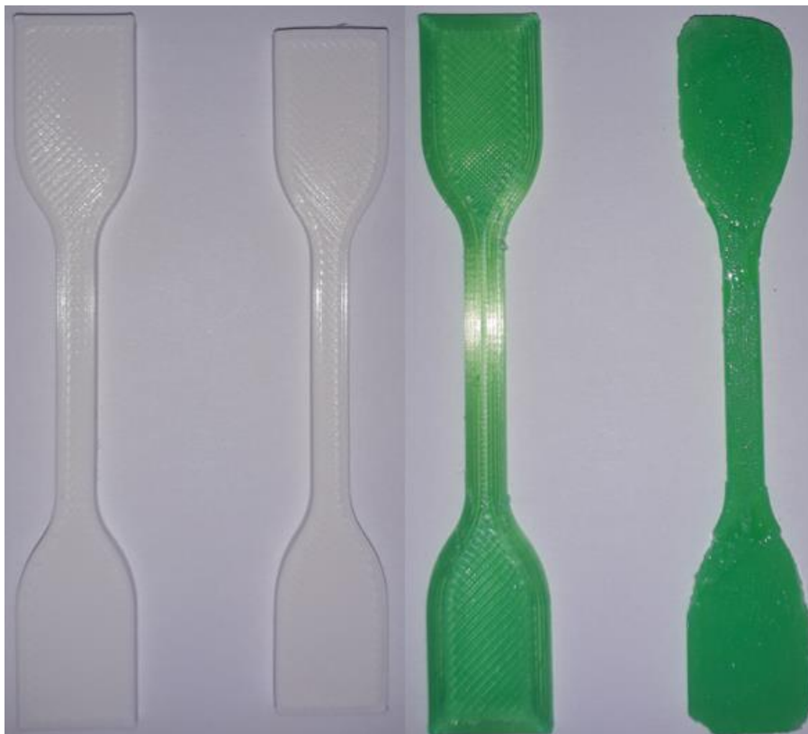
Slika 5.20. Epruvete žarene na 150°C
