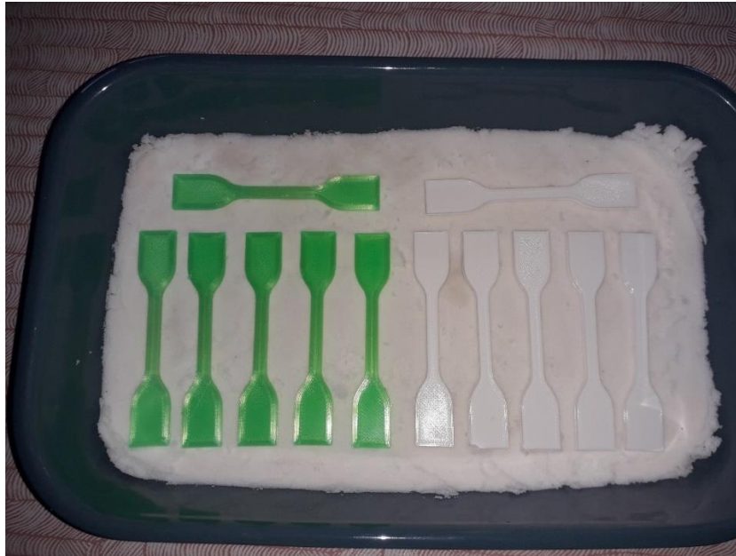
Slika 5.9. Raspored epruveta u posudi za žarenje
