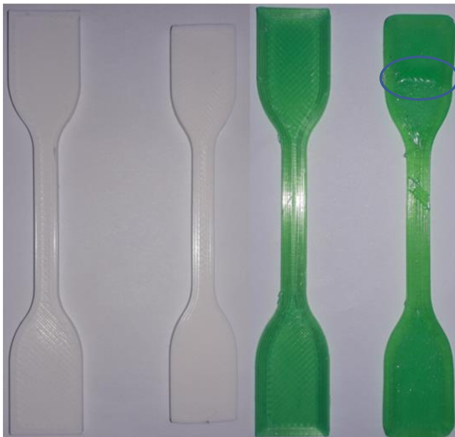
Slika 5.16. Epruvete žarene na 110°C
