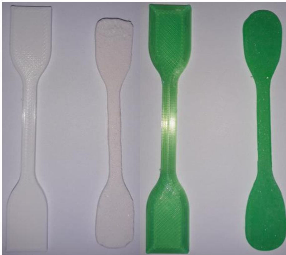
Slika 5.21. Epruvete žarene na 160°C
