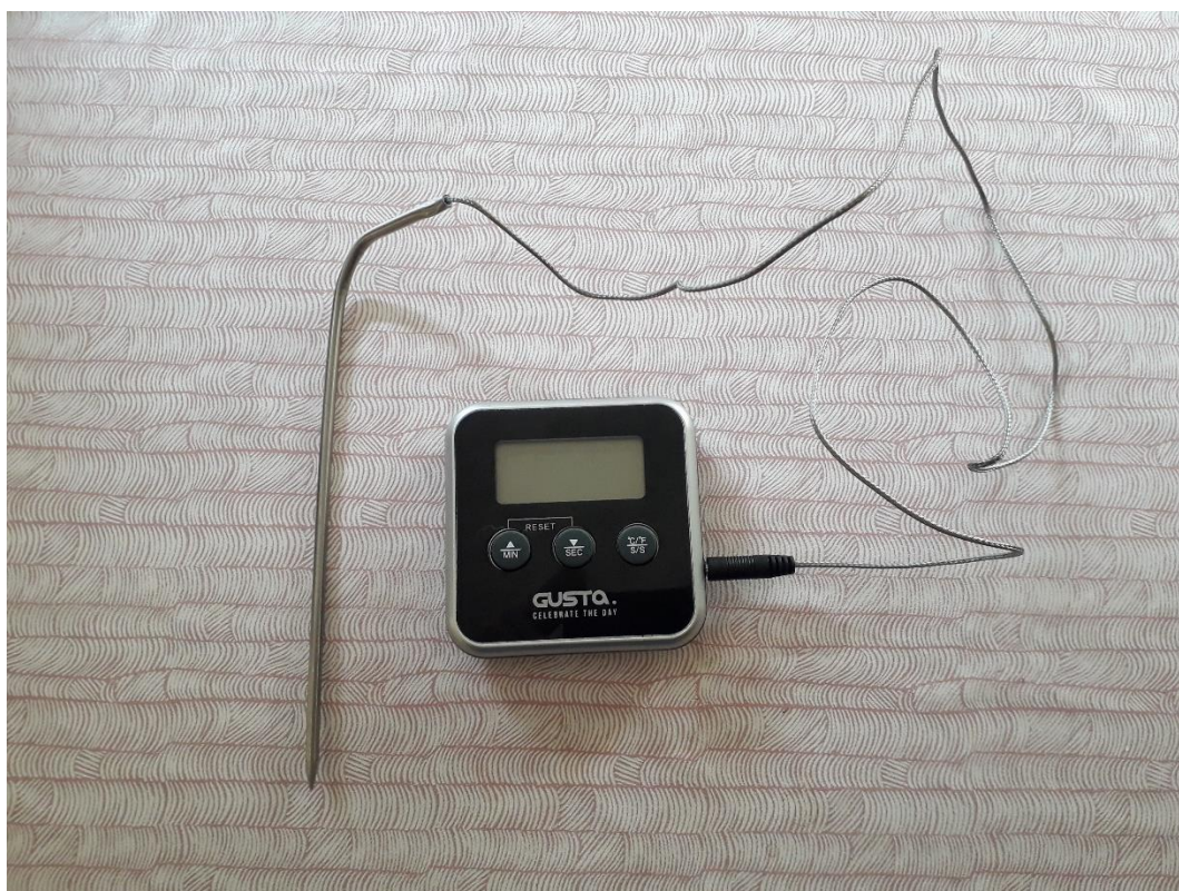
Slika 5.7. Termometar za kontrolu temperature epruveta u soli
