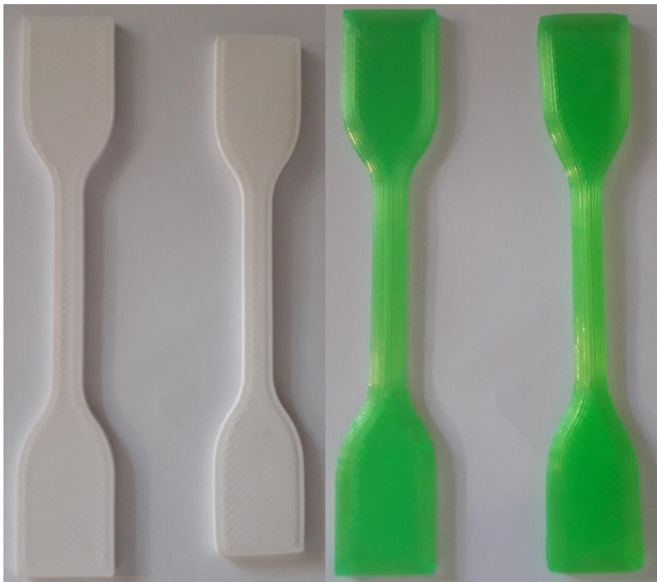
Slika 5.14. Epruvete žarene na 100°C
