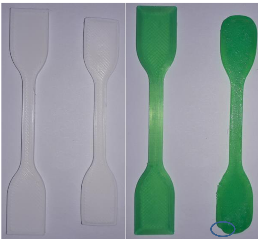
Slika 5.17. Epruvete žarene na 120°C
