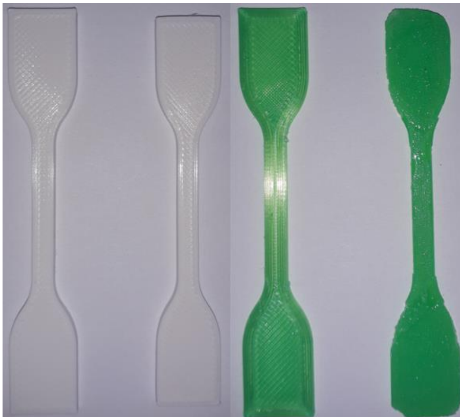
Slika 5.20. Epruvete žarene na 150°C
