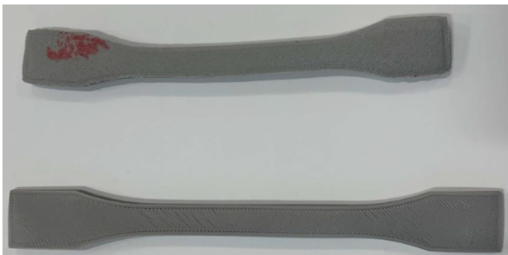
Slika 4.11. Deformacije ispitnog tijela od Al-ASA nakon žarenja [16]
