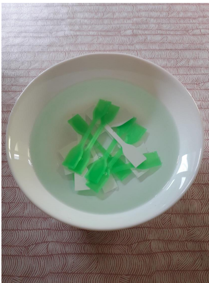
Slika 5.13. Otapanje viška soli s površine epruveta
