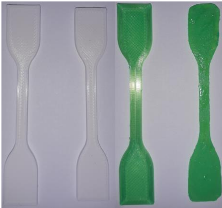
Slika 5.19. Epruvete žarene na 140°C
