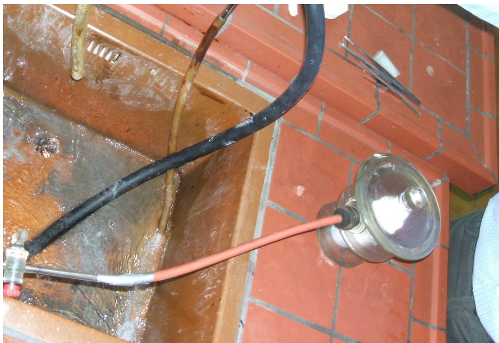
Slika 3.3. Uklanjanje mjehurića zraka u eksikatoru.
