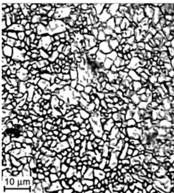
Slika 2.1. Mikrostruktura sitnozrnate aluminij oksidne keramike [19].
