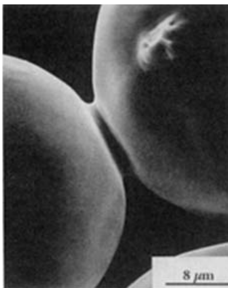
Slika 2.13. Stvaranje "vrata" na mjestu kontakta između čestica [22].
