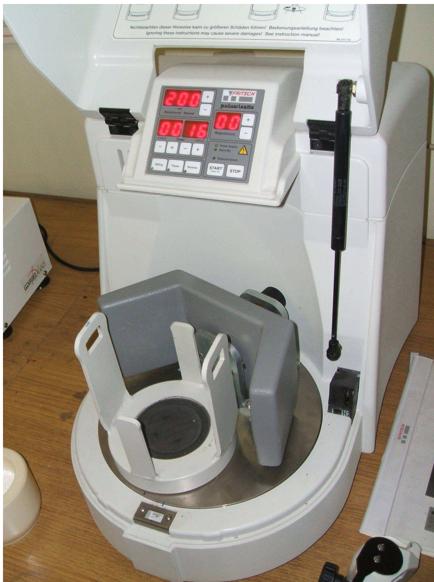
Slika 3.2. Planetarni kuglični mlin (Pulverisette 6, Fritsch, Germany).
