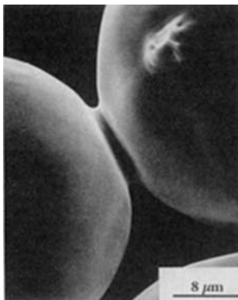
Slika 2.13. Stvaranje "vrata" na mjestu kontakta između čestica [22].
