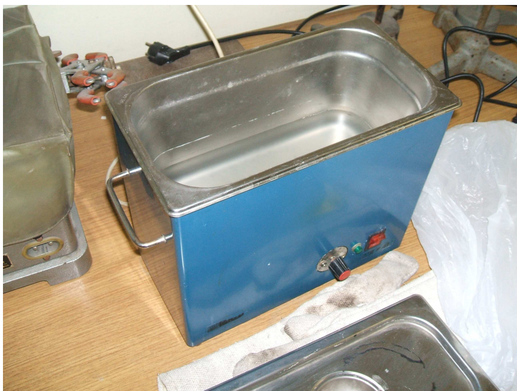
Slika 3.4. Uklanjanje mjehurića zraka u ultrazvučnoj kupelji.
