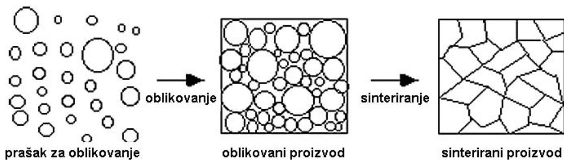
Slika 2.7. Zgušnjavanje mase oblikovanjem za daljnju obradu (sinteriranje [21]).
