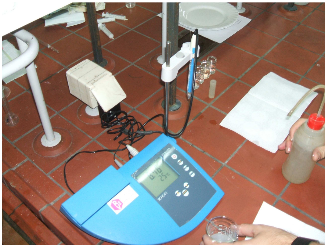
Slika 3.5. Mjerenje pH vrijednosti suspenzije.
