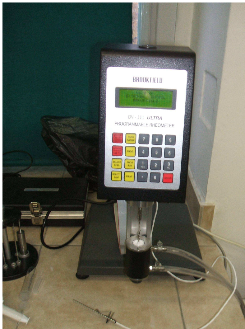
Slika 3.6. Rotacijski viskozimetar (Brookfield DV-III Ultra, U.S.A.).
