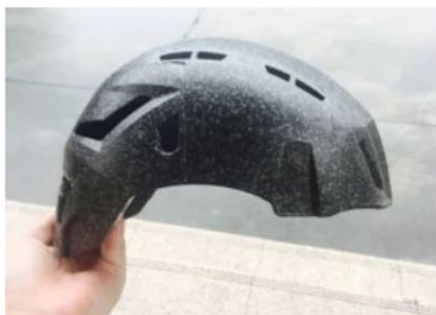
Slika 7. Apsorpcijski sloj a) od EPS-a [24] b) od EPP-a [25]
