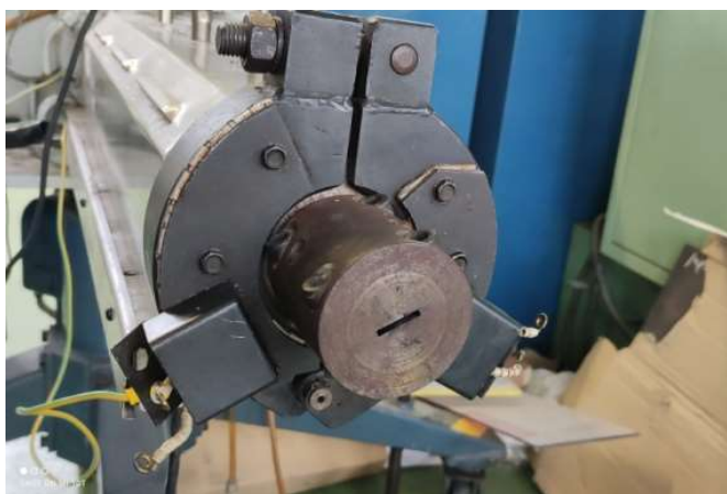
Slika 9. Vanjski par grijača na alatu ekstrudera
