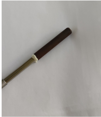
Slika 29. PT 100 sonda montirana u modificirani svornjak
