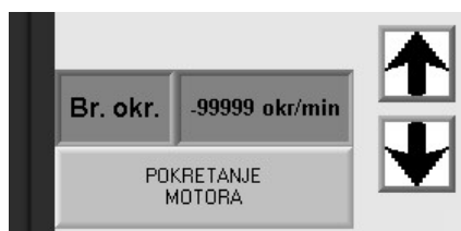
Slika 54. Tipkala za regulaciju brzine vrtnje motora
