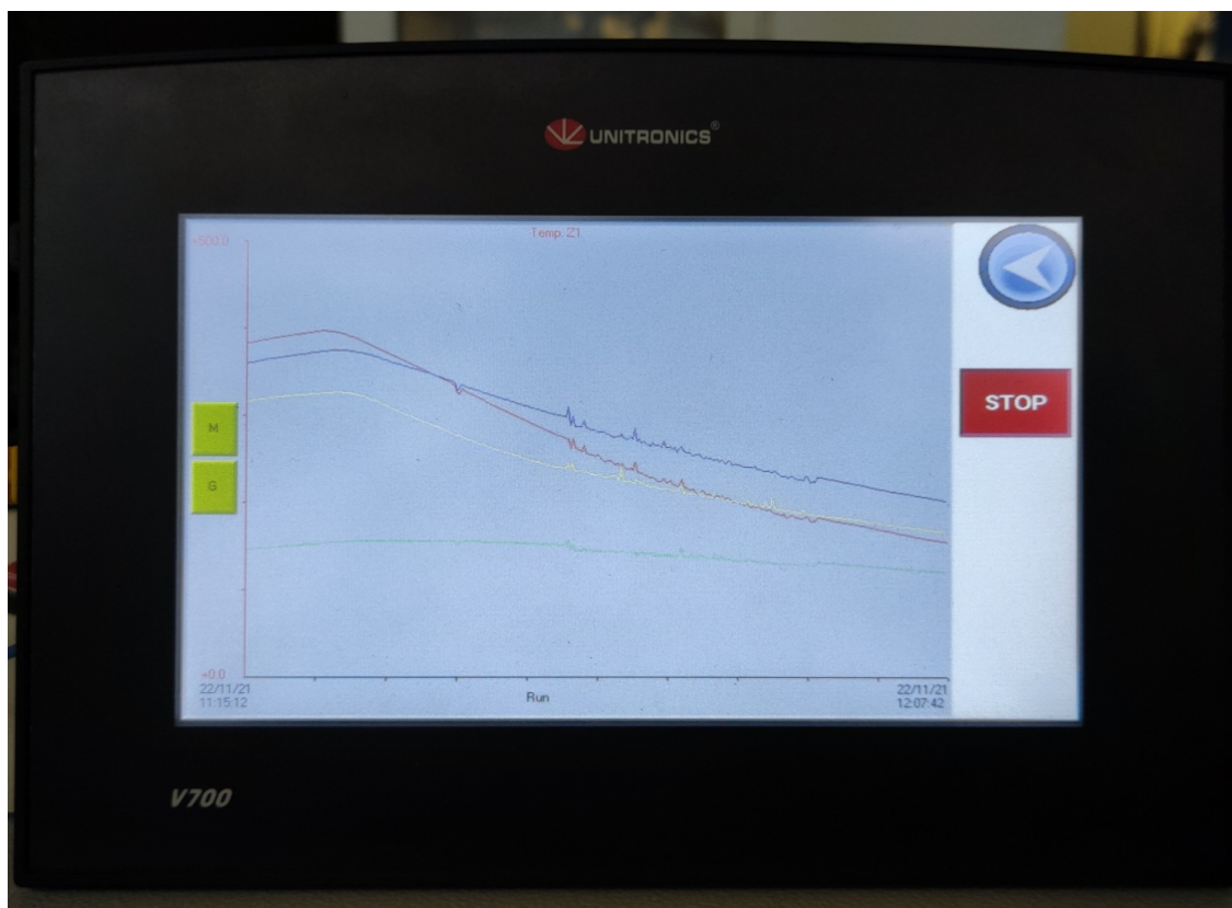
Slika 23. Šumovi kod pokretanja motora
