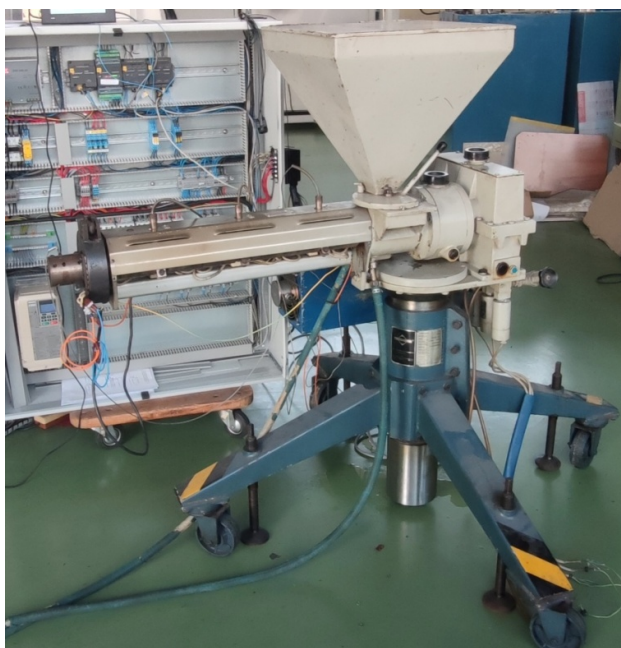
Slika 1. Ekstruder marke Trusioma, tip E1-32-20
