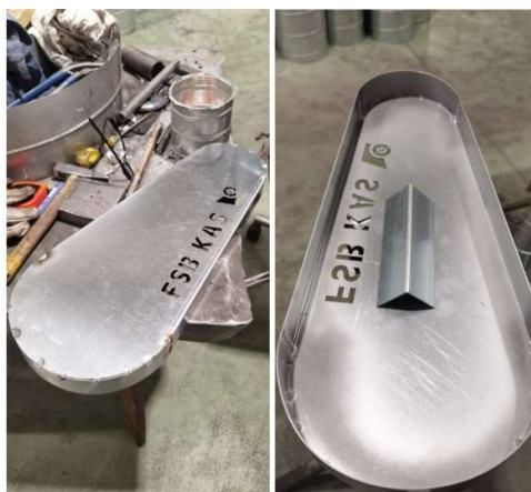
Slika 44. Poklopac remenskog prijenosa pogonskog motora
