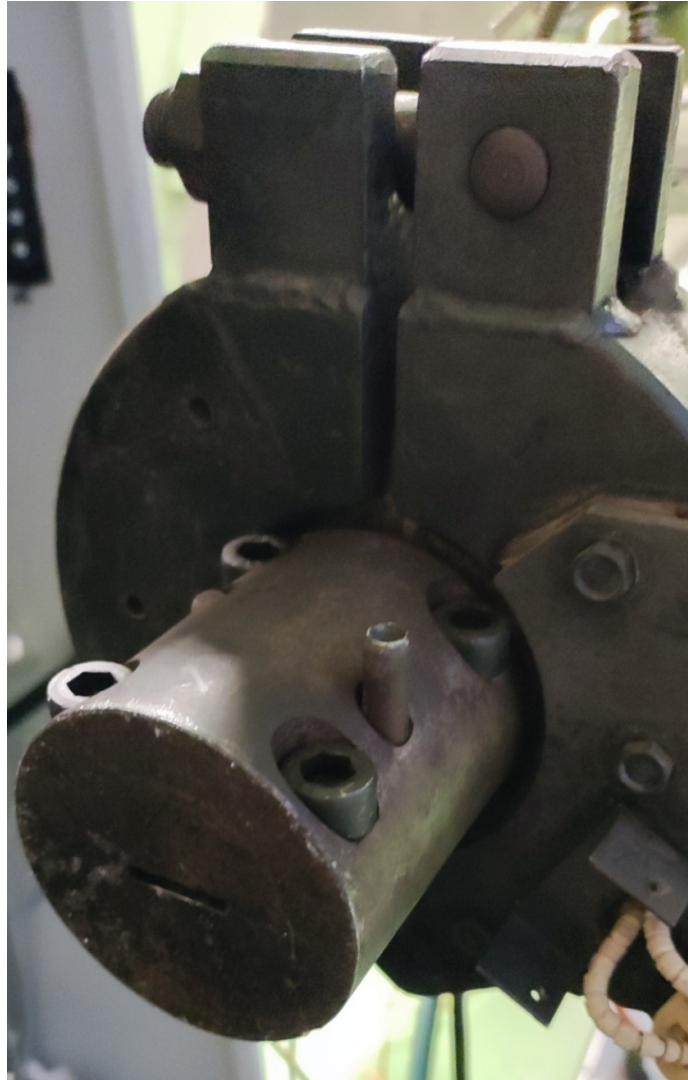
Slika 36. Glava ekstrudera s jednim ispravnim grijačem
