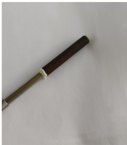
Slika 29. PT 100 sonda montirana u modificirani svornjak
