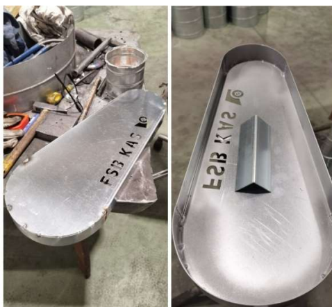
Slika 44. Poklopac remenskog prijenosa pogonskog motora
