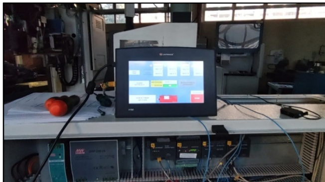
Slika 27. Testni položaj PLC uređaja
