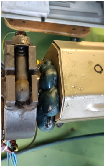
Slika 41. Izbacivanje alata ekstrudera
