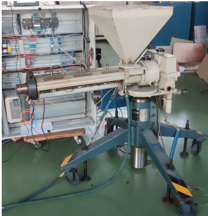
Slika 7. Stroj za ekstrudiranje polimera Trusioma E1-32-20
