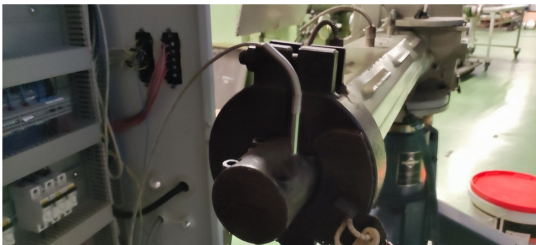
Slika 30. PT 100 sonda montirana u alat ekstrudera
