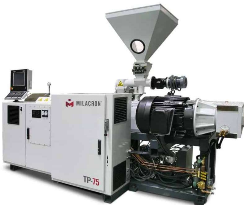
Slika 2. Moderan ekstruder tvrtke Milacron [2]
