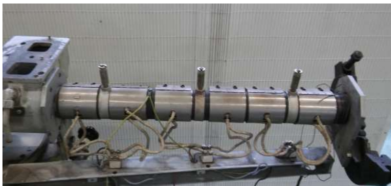
Slika 8. Prstenasti grijači na cilindru za taljenje
