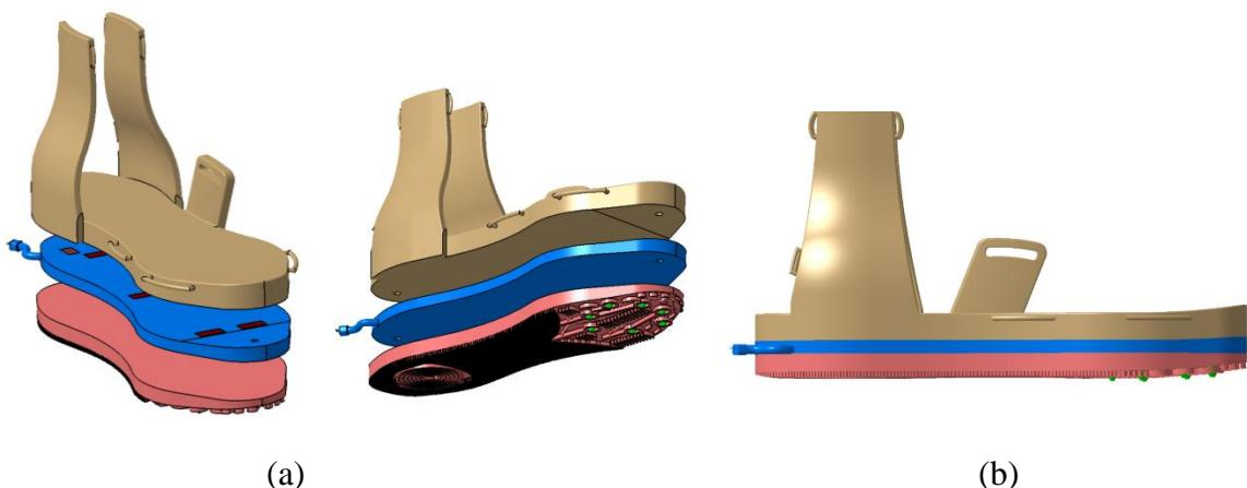
**Slika 40.** Sklop CAD modela s gumenim potplatom za mokru i klizavu podlogu: a) Rastavljen sklop; b) Bokocrt sklopa
