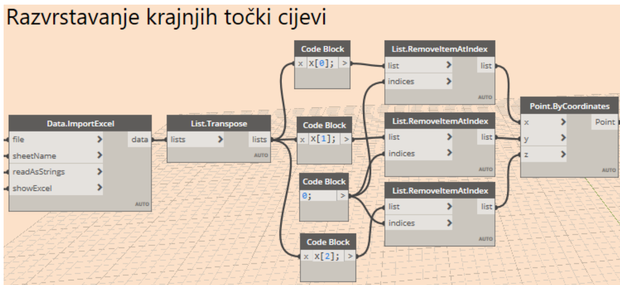
Slika 32. Algoritam za razvrstavanje krajnjih točki cijevi
