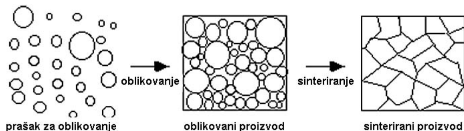
Slika 8. Zgušnjavanje mase oblikovanjem za daljnju obradu (sinteriranje).
