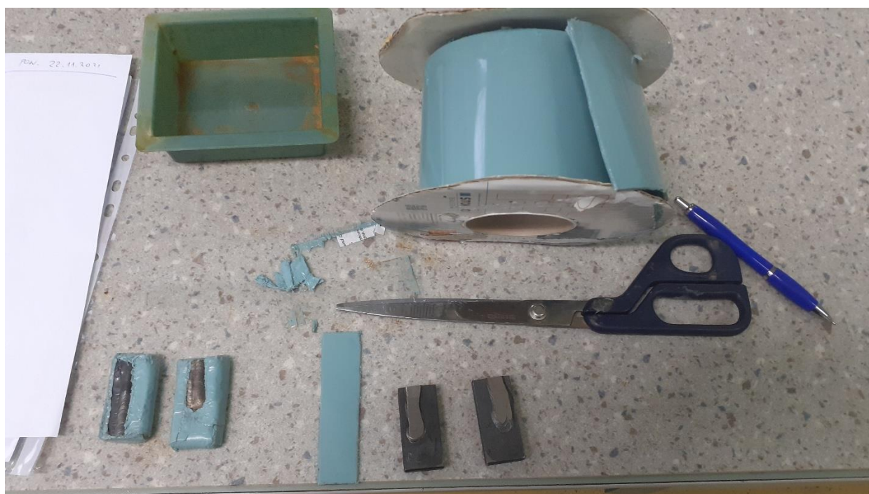
Slika 34. Postupak izolacije osnovnog materijala [23]
