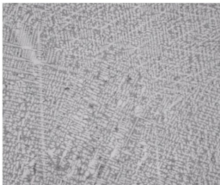
Slika 14. Mikrostruktura stelita 12 s povećanjem 500x [14]
