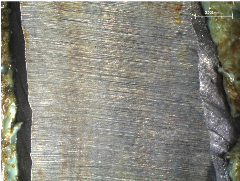
Slika 42. C2TO uzorak nakon korozije
