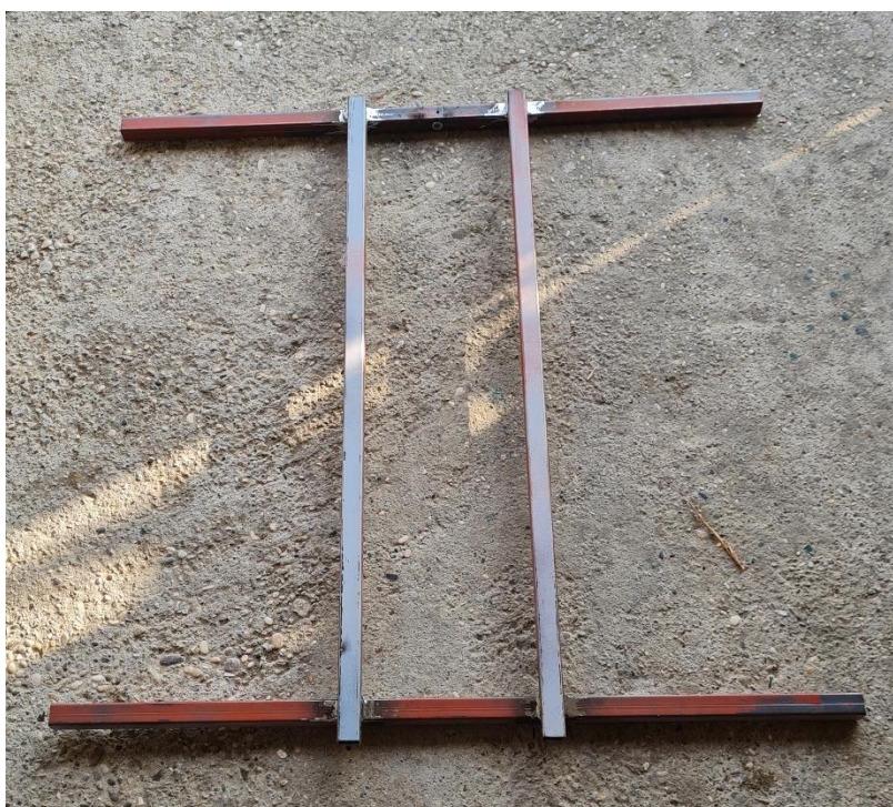
Slika 23. Izrađeno postolje konstrukcije
