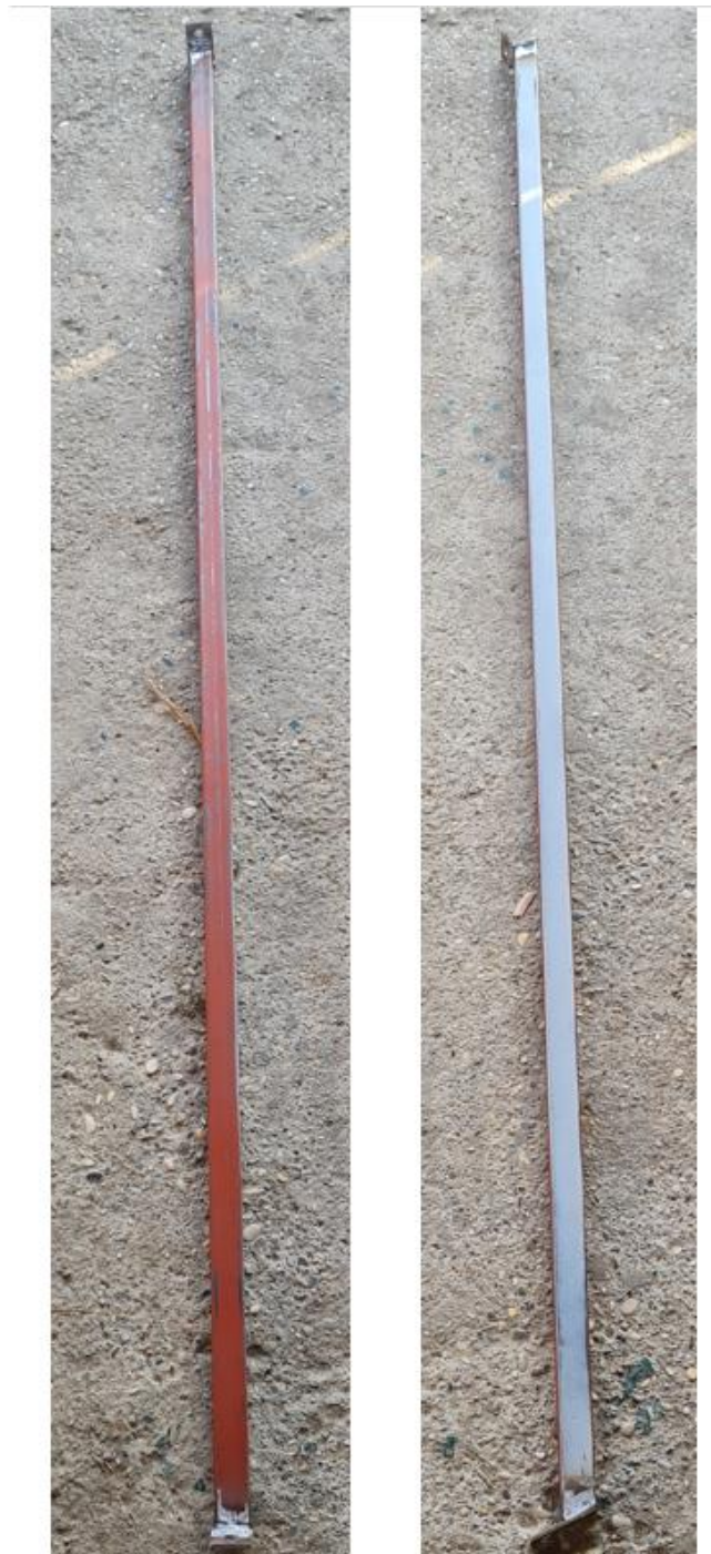
Slika 25. Upora za dodatnu stabilnost
