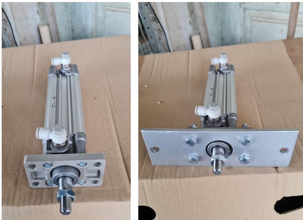
Slika 29. Montaža prirubnice i nosača cilindra
