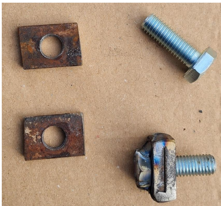
Slika 27. Vijci za montažu nosača cilindara na stupove
