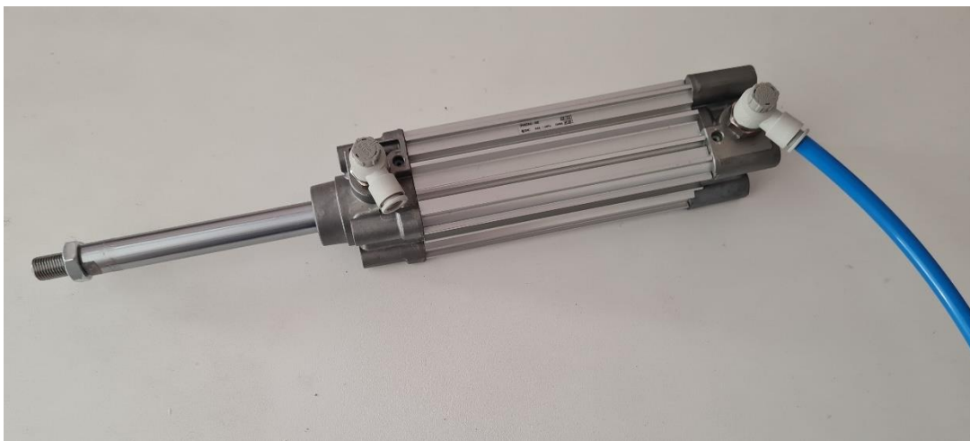
Slika 40. Test cilindra – izlaz klipnjače
