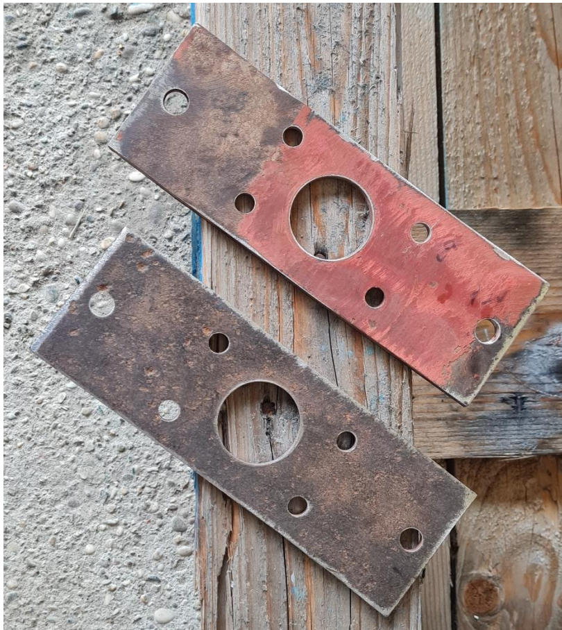
Slika 26. Izrađeni dodatni nosači za cilindre
