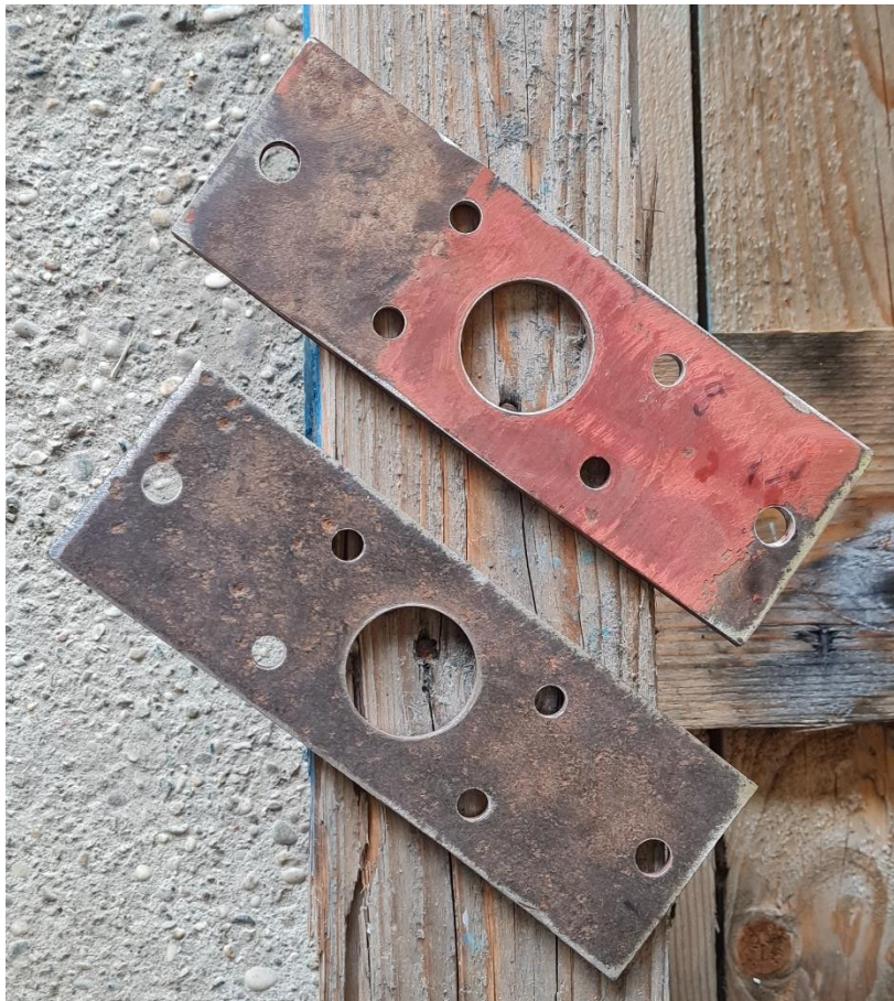
Slika 26. Izrađeni dodatni nosači za cilindre
