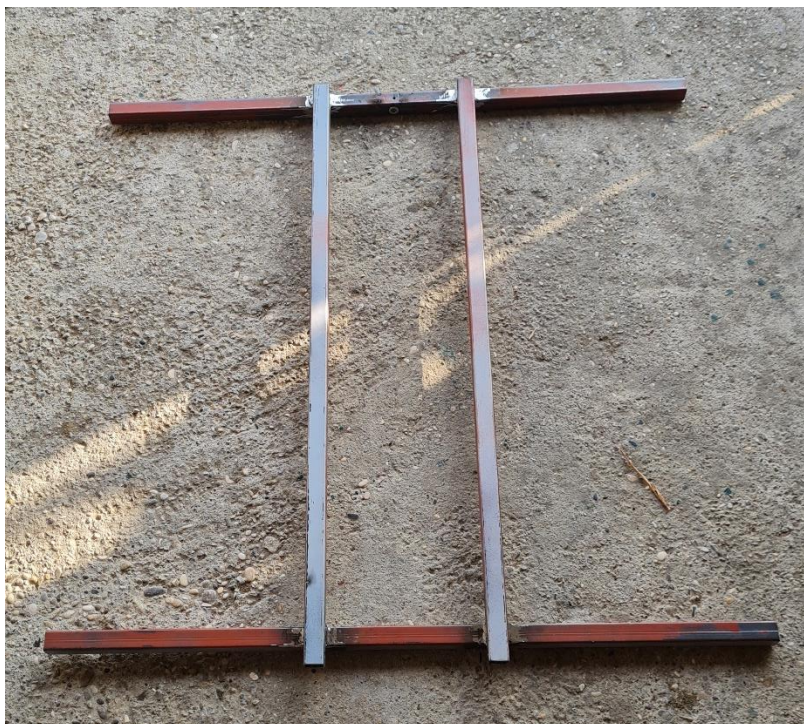
Slika 23. Izrađeno postolje konstrukcije
