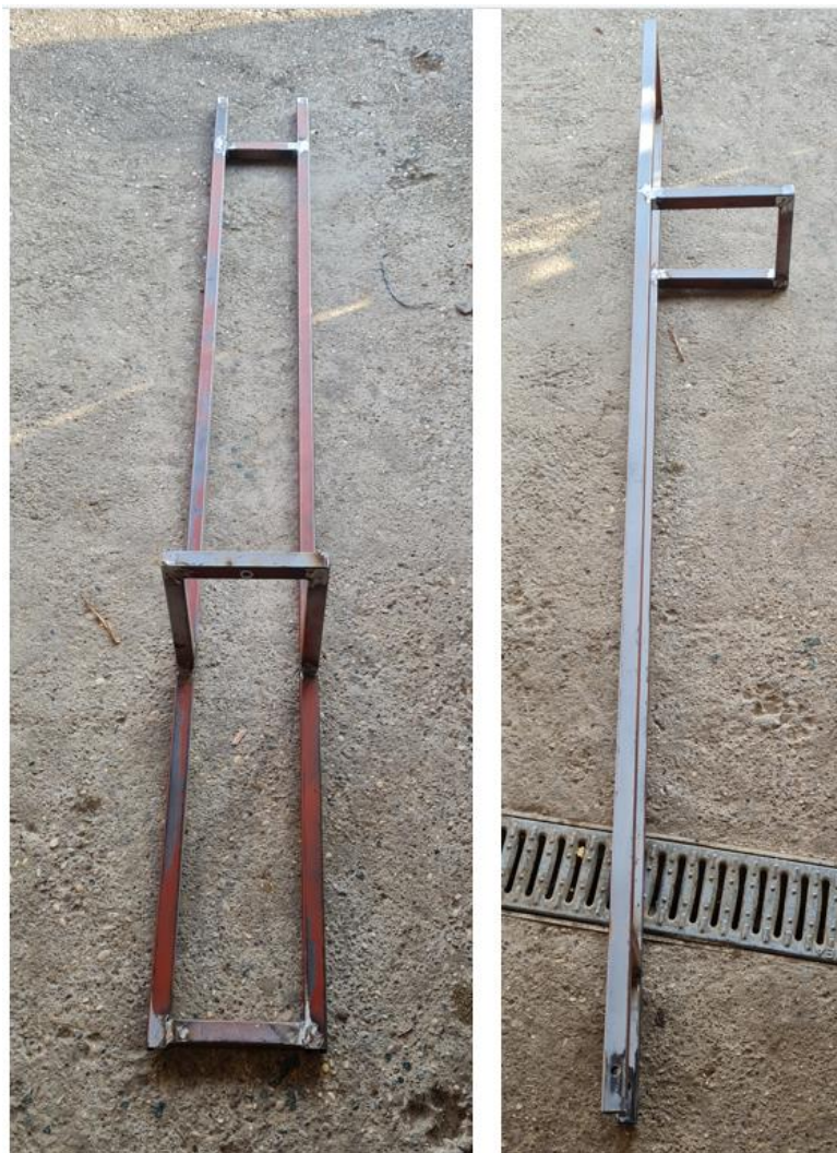
Slika 24. Stupovi konstrukcije po kojima klize cilindri
