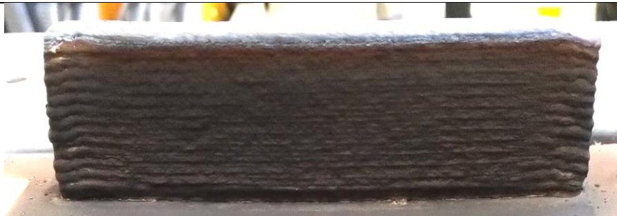
Slika 24. Navareni zid dupleks čelika
