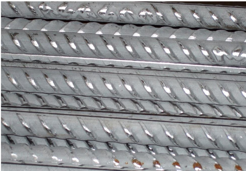
Slika 11. Armatura proizvedena od dupleks čelika [6]
