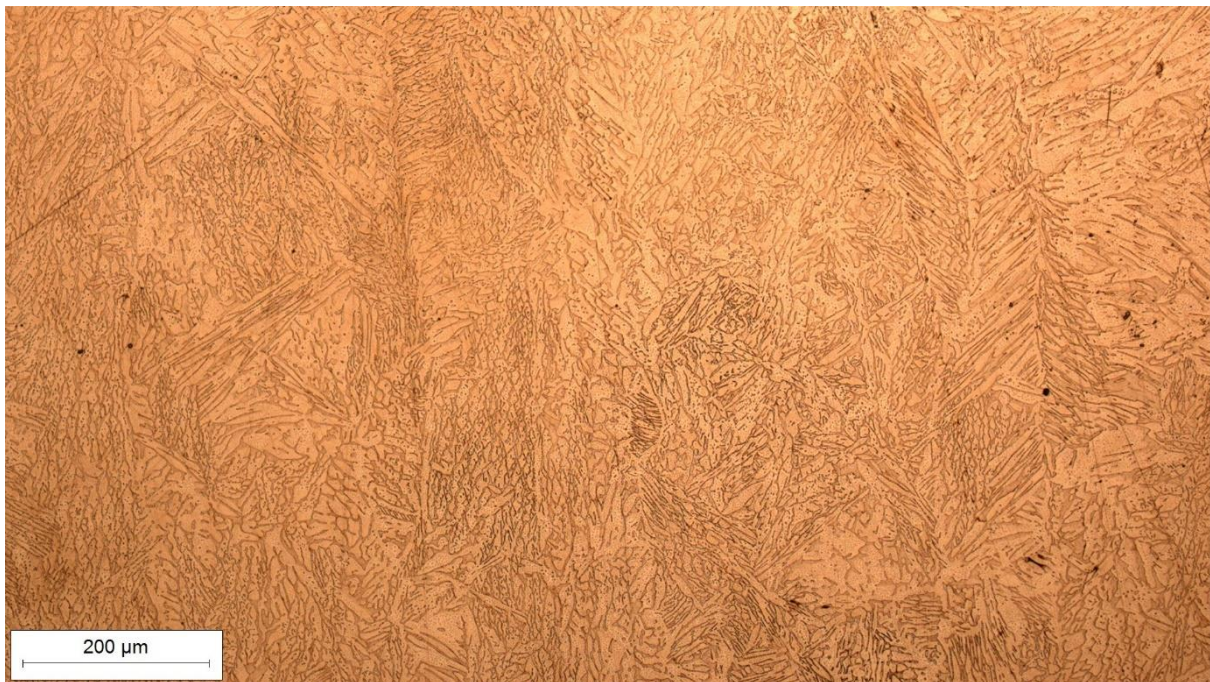
Slika 46. Mikrostruktura uzorka 5 B snimljena pri povećanju od 100×
