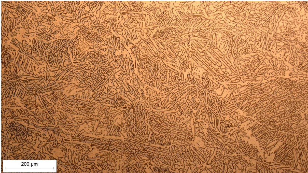
Slika 44. Mikrostruktura uzorka 4 B3 snimljena pri povećanju od 100×
