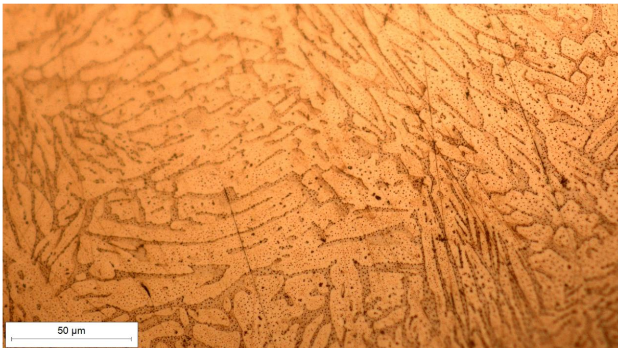
Slika 49. Mikrostruktura uzorka 5 B3 snimljena pri povećanju od 500×
