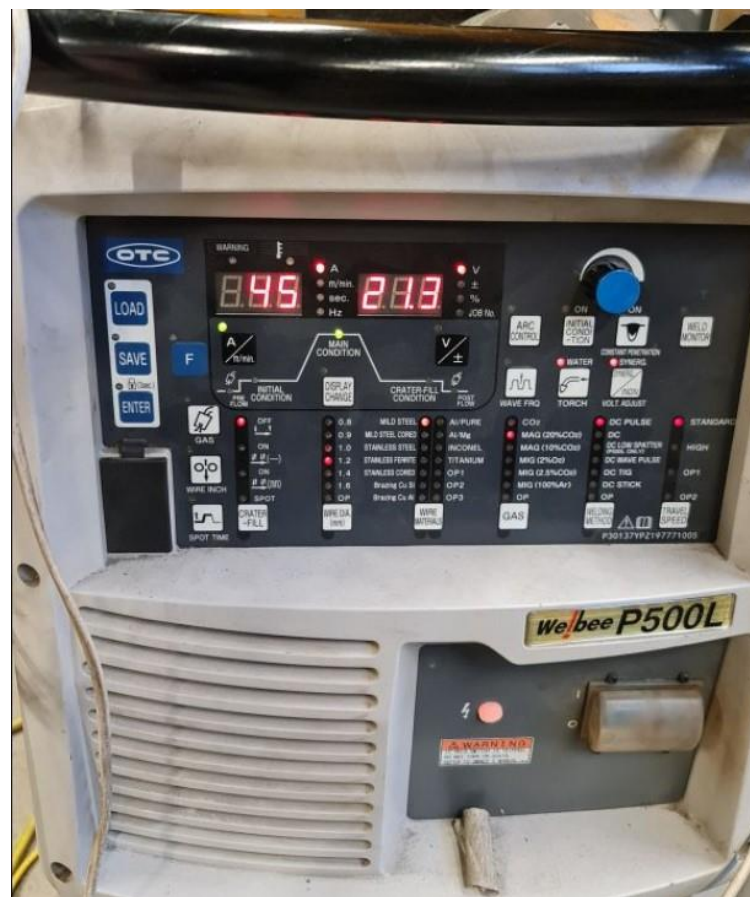
Slika 28. Parametri struje i napona prije na početku taloženja
