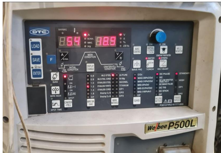
Slika 29. Parametri struje i napona pred kraj taloženja
