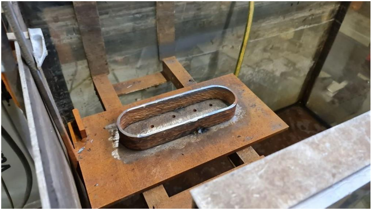
Slika 34. Poligon (podloga) za taloženje predforme
