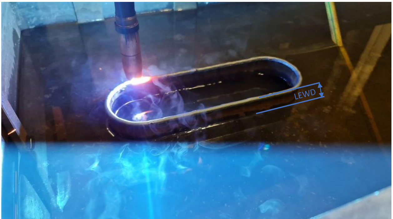
Slika 35. Predforma nekoliko slojeva nakon početka taloženja i prikaz LEWD-a
