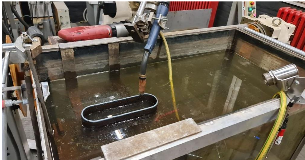
Slika 36. Predforma nakon završetka taloženja
