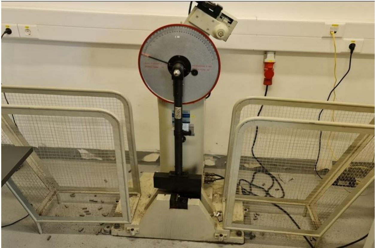
Slika 46. Charpyev bat za ispitivanje udarne radnje loma (Proizvodnja Dalekovod)
