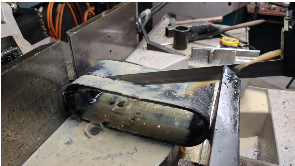
Slika 37. Izrezivanje iskoristivog dijela predforme
