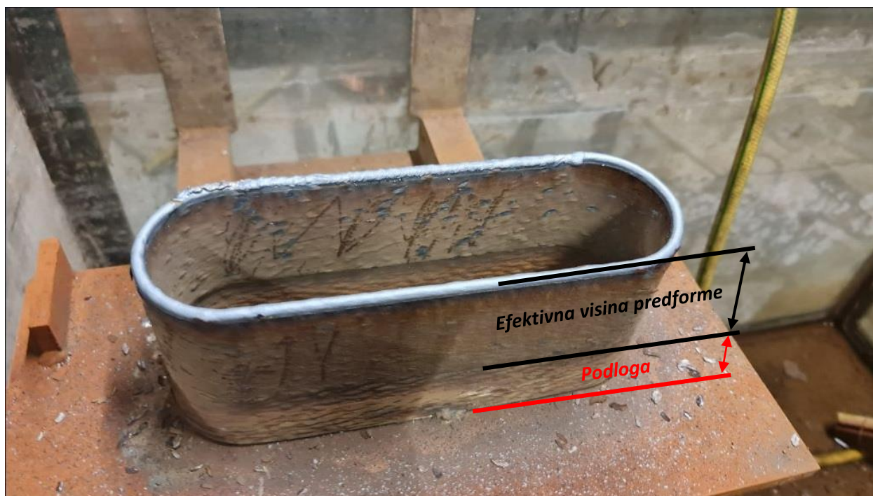
Slika 33. Završena predforma, još uvijek neizrezana s podloge
