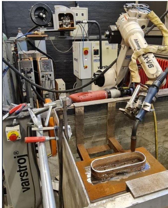
Slika 31. Kompletan sustav za taloženje predforme
