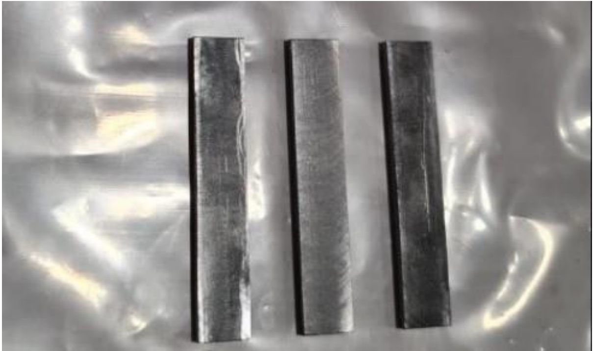
Slika 43. Gotovi uzorci, spremni za izradu V-utora
