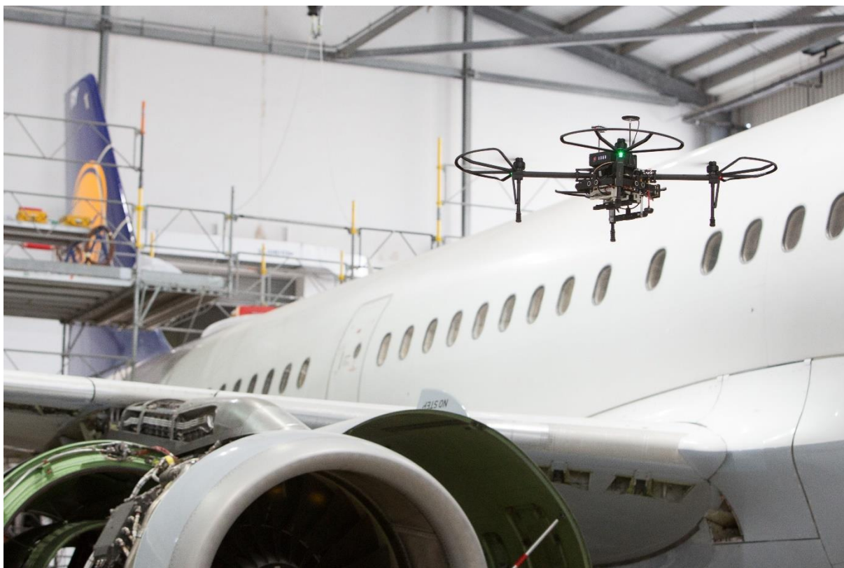
Slika 3. Vizualni pregled zrakoplova pomoću drona [7]
