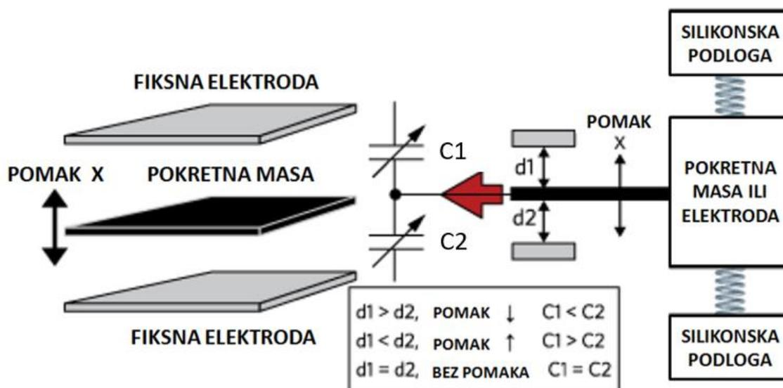
Slika 12. Princip rada kapacitivnog MEMS akcelerometra [23]
