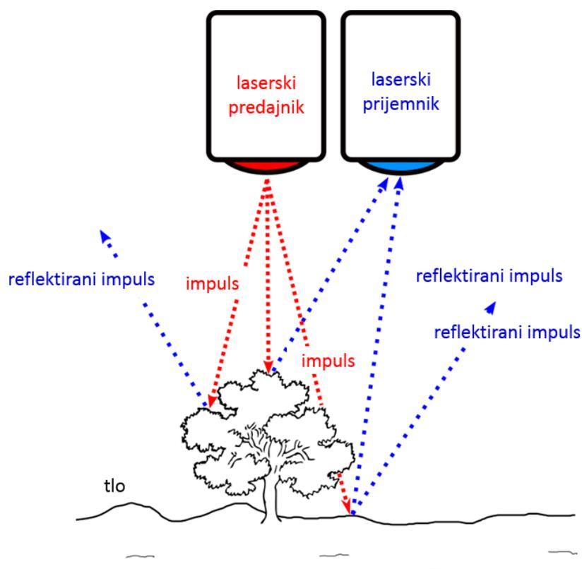
Slika 17. Princip rada LiDAR senzora [29]
