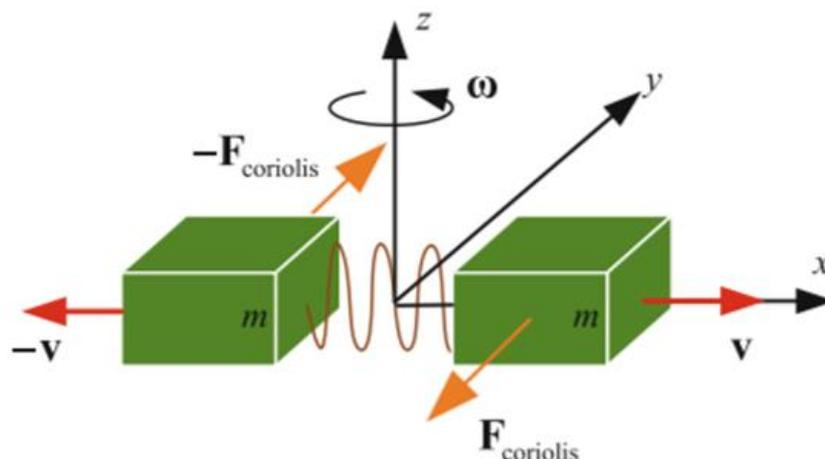
Slika 13. Princip rada MEMS žiroskopa [24]
