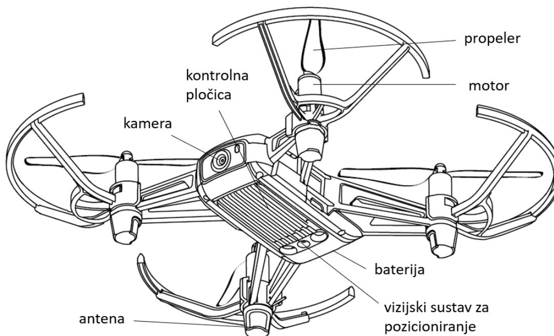
Slika 8. Dijelovi drona [16]
