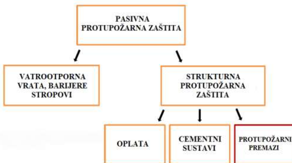
Slika 7. Shematski prikaz pasivne protupožarne zaštite [18]
