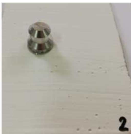
Slika 36. Ispitivanje prionjivosti na ispitnim uzrocima
