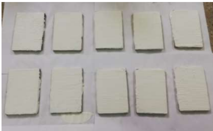
Slika 29. Prikaz svih deset ispitnih uzorka nakon nanosenog drugog sloja premaza
