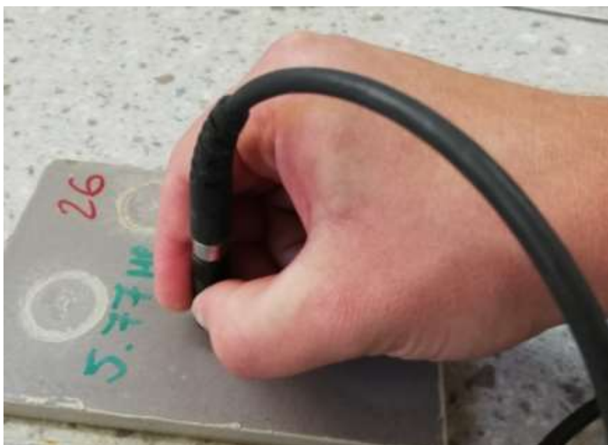
Slika 23. Prikaz tehnike mjerenja debljine premaza
