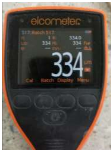
Slika 22. Uređaj za mjerenje debljine premaza „Elcometer 456“
