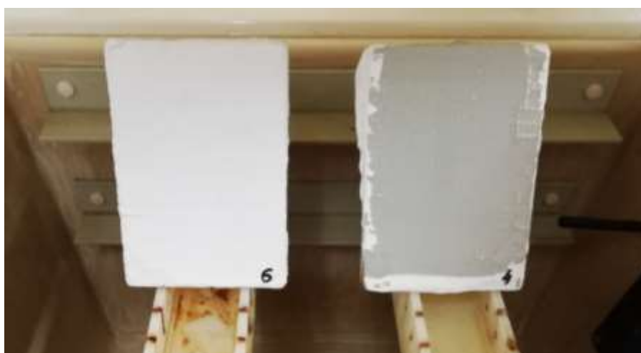
Slika 33. Uzorci 4 i 6 nakon izloženosti vlažnim uvjetima 96 sati
