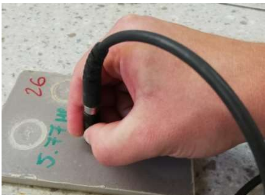
Slika 23. Prikaz tehnike mjerenja debljine premaza
