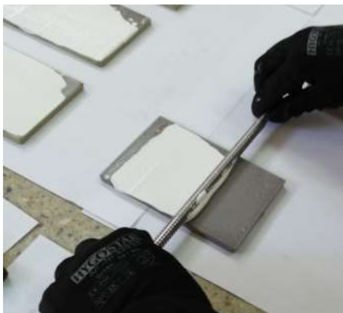
Slika 26. Nanošenje prvog sloja ekspandirajućeg premaza pomoću spiralnog aplikatora
