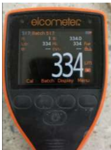
Slika 22. Uređaj za mjerenje debljine premaza „Elcometer 456“
