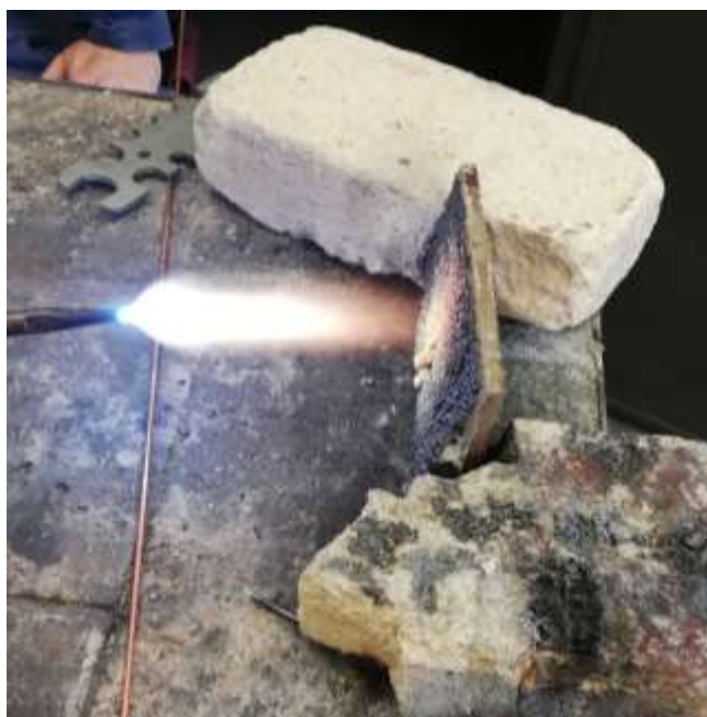
Slika 42. Provođenje eksperimenta paljenja uzoraka
