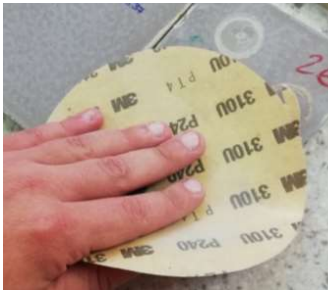
Slika 25. Brušenje ispitnih uzoraka prije nanosa prvog sloja ekspandirajućeg premaza
