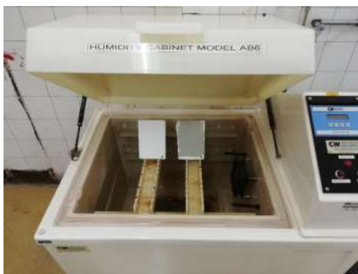
Slika 32. Uzorci 4 i 6 u vlažnoj komori
