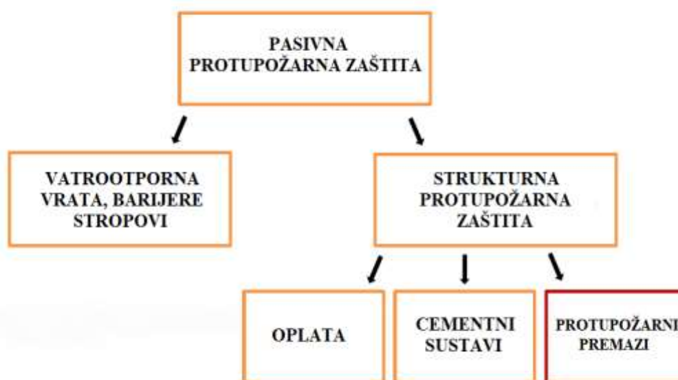
Slika 7. Shematski prikaz pasivne protupožarne zaštite [18]
