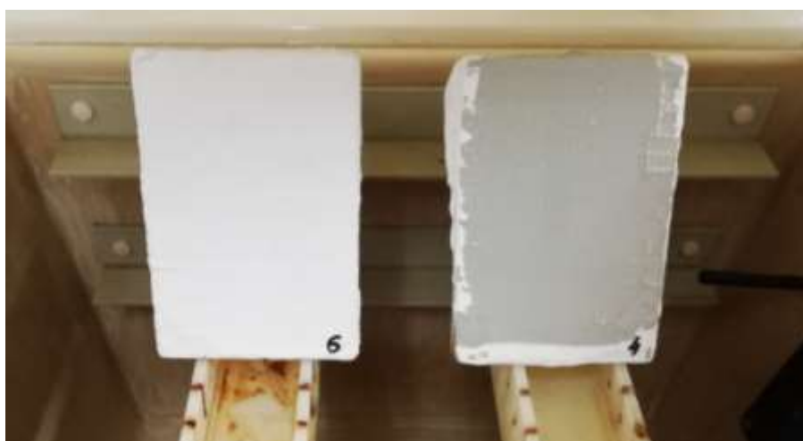
Slika 33. Uzorci 4 i 6 nakon izloženosti vlažnim uvjetima 96 sati
