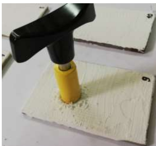
Slika 37. Strugač za pripremu uzorka prije ispitivanje prionjivosti
