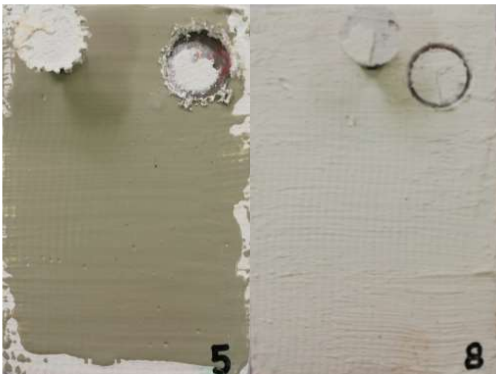
Slika 41. Ispitni uzorci 5 i 8 nakon provedenog ispitivanja prionjivosti „Pull off“ metodom
