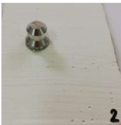
Slika 36. Ispitivanje prionjivosti na ispitnim uzrocima
