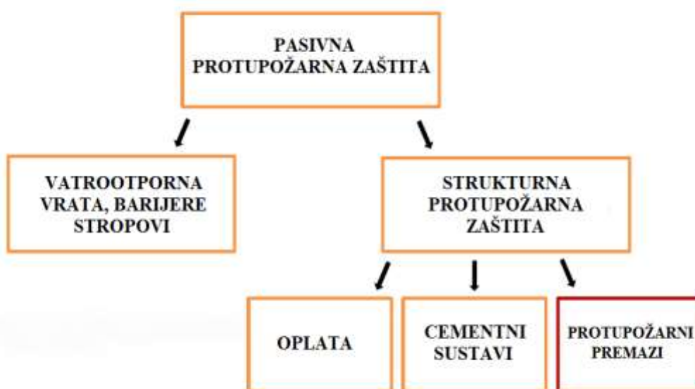
Slika 7. Shematski prikaz pasivne protupožarne zaštite [18]
