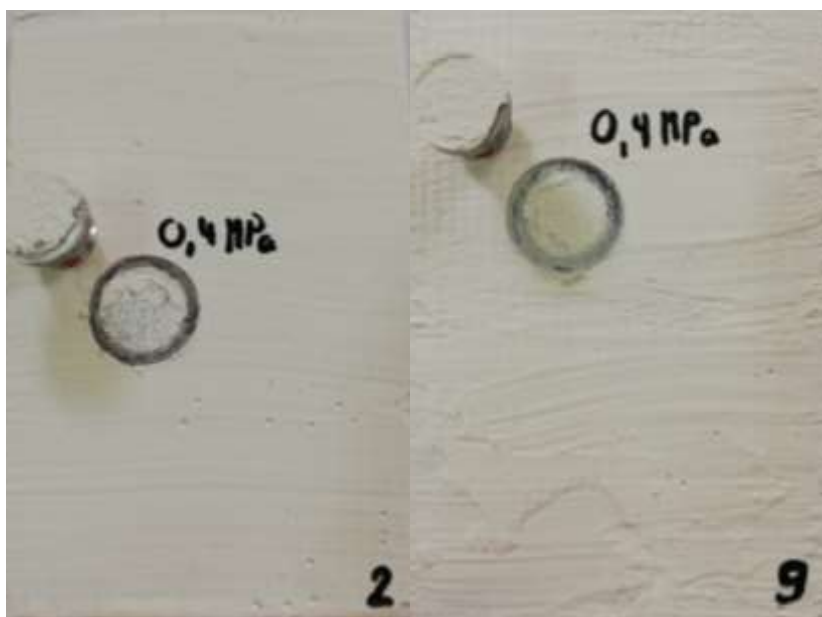
Slika 39. Ispitni uzorci 2 i 9 nakon provedenog ispitivanja prionjivosti „Pull off“ metodom
