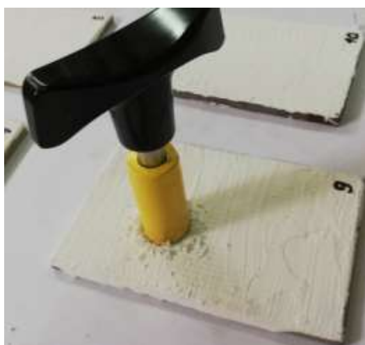
Slika 37. Strugač za pripremu uzorka prije ispitivanje prionjivosti
