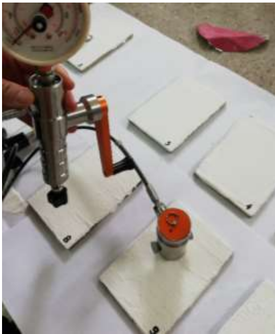
Slika 38. Tehnika i uređaj za ispitivanje prionjivosti pomoću „Pull off“ metode
