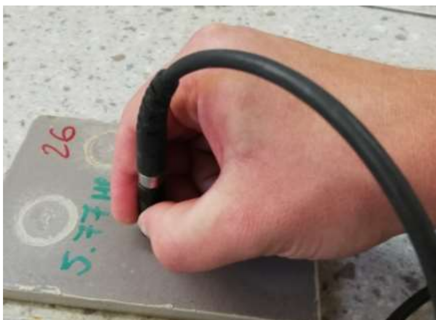
Slika 23. Prikaz tehnike mjerenja debljine premaza
