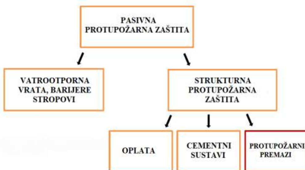
Slika 7. Shematski prikaz pasivne protupožarne zaštite [18]
