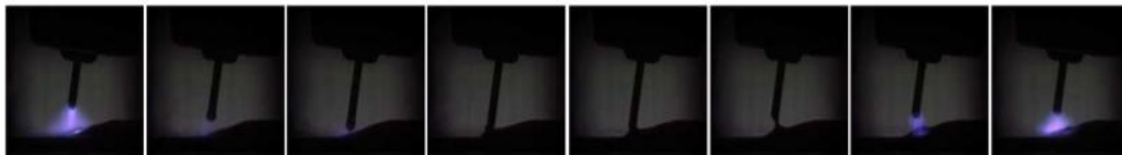
Slika 33. Slijed odvajanja kapljice kod CMT postupka [17]
