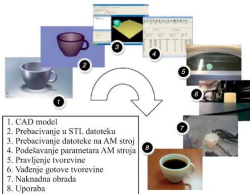
Slika 3. Princip i faze aditivne proizvodnje [2]
