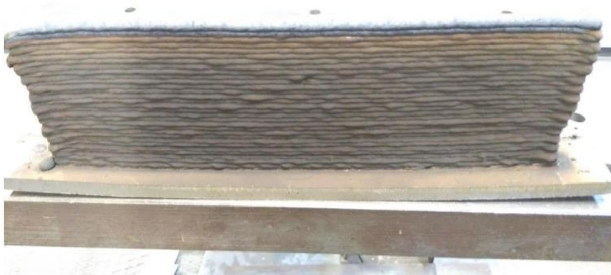
Slika 39. Zid izrađen postupkom coldArc [25]
