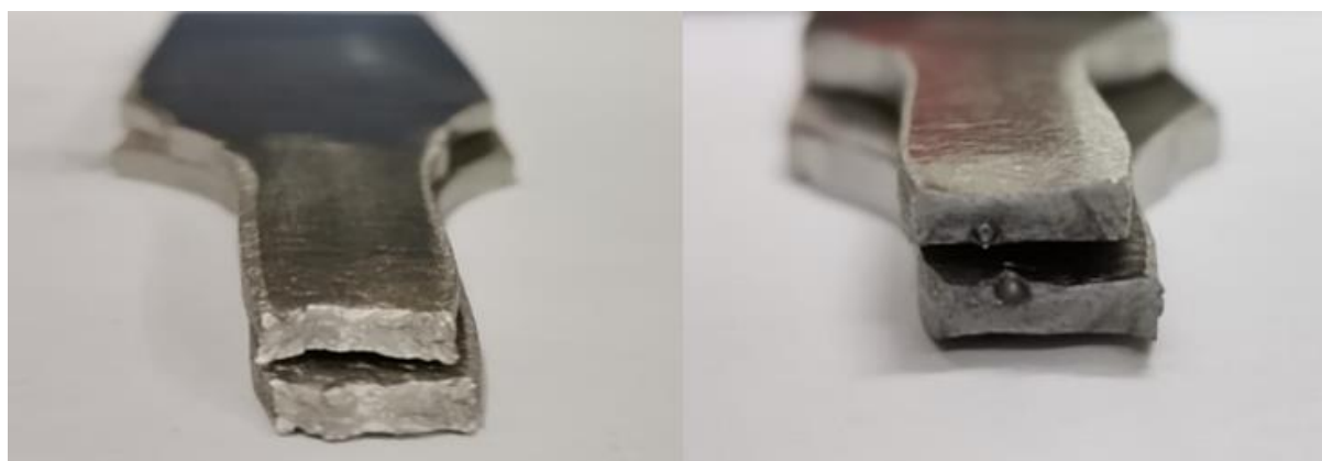
Slika 76. Poprečni presjek epruvete V (lijevo) i VT (desno) nakon kidanja
