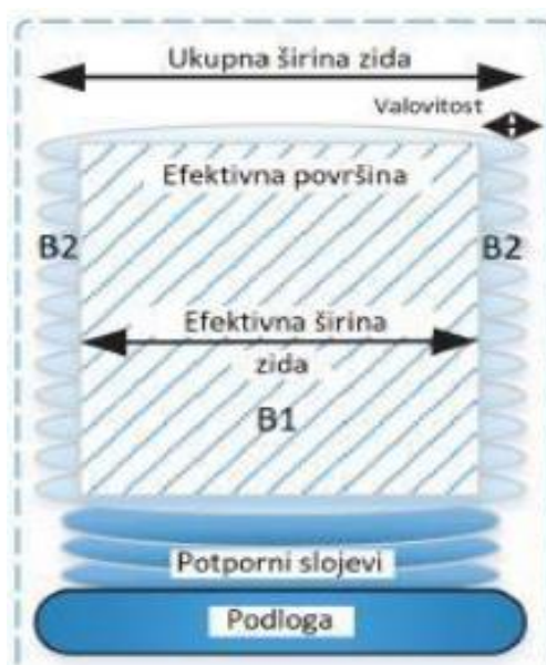
Slika 5. Zid izrađen WAAM postupkom [5]
