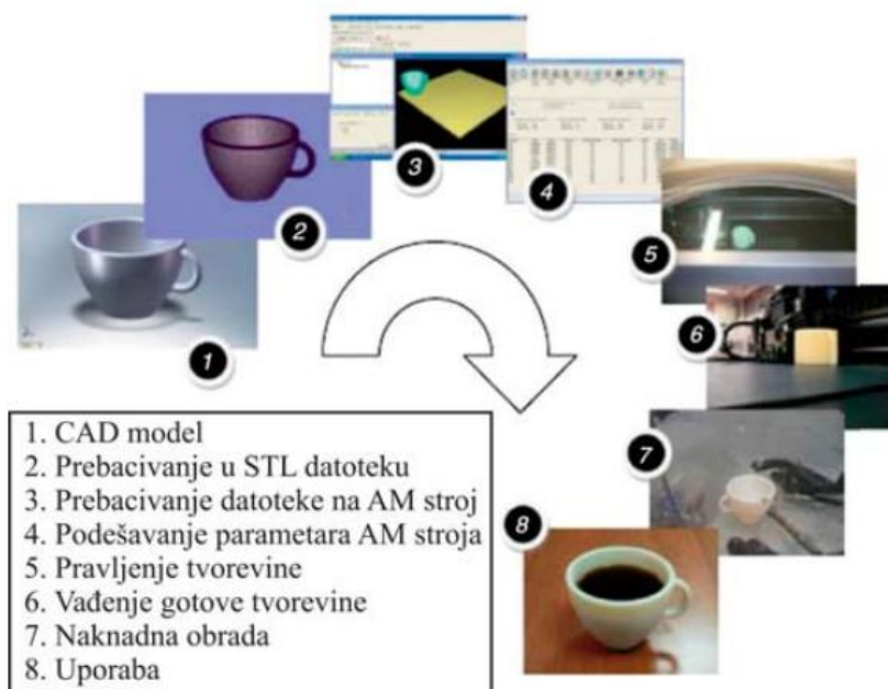
Slika 3. Princip i faze aditivne proizvodnje [2]
