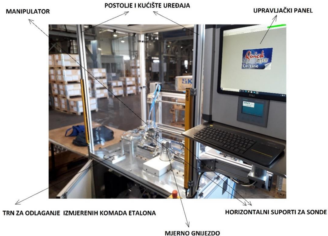
Slika 23. Prikaz kontaktnog mjernog sustava s označenim glavnim dijelovima [22]
