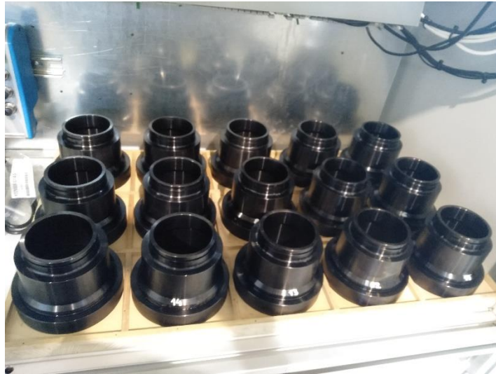
Slika 32. Uzorci prstena ležaja [24]
