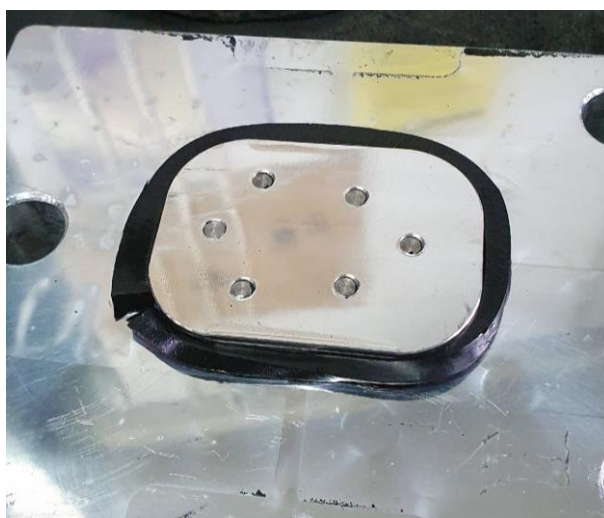
Slika 7.31. Punjenje kalupne šupljine EPDM-om - varijanta 2
