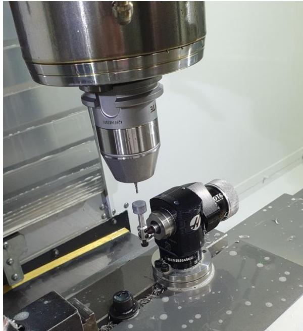
Slika 7.15. Sustav za automatsko umjeravanje alata
