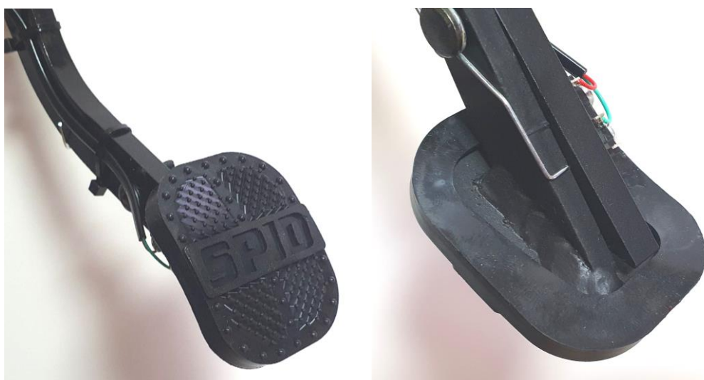
Slika 7.33. Izrađena gumena zaštita pedale
