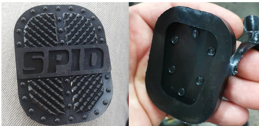
Slika 7.33. Izrađena gumena zaštita pedale
