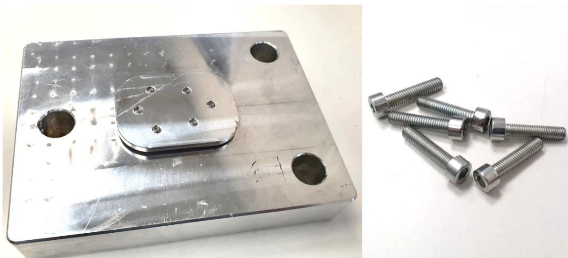
Slika 7.25. Sklapanje gornje ploče kalupa s jezgrom
