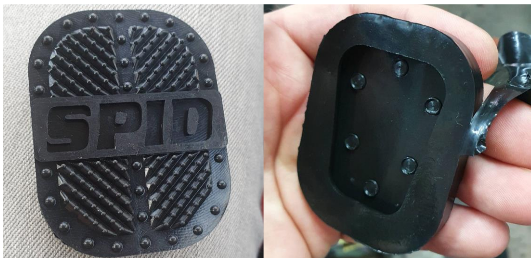
Slika 7.33. Izrađena gumena zaštita pedale
