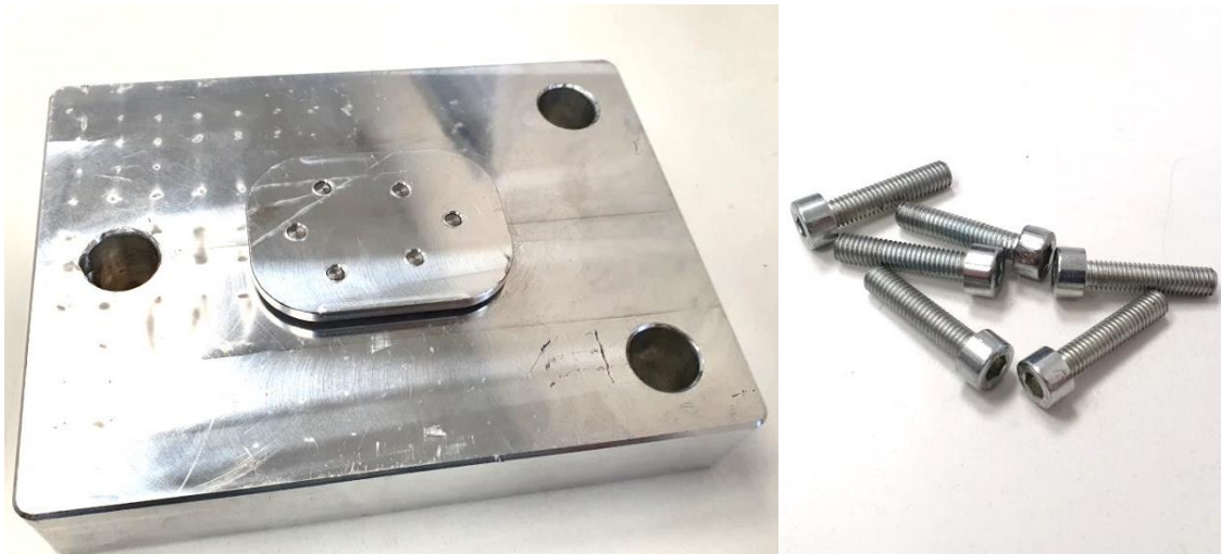
Slika 7.25. Sklapanje gornje ploče kalupa s jezgrom
