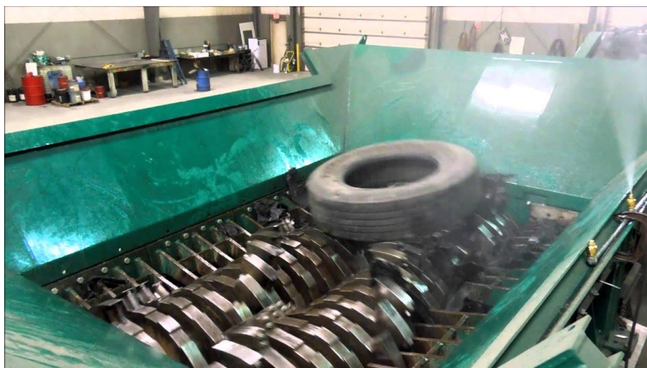
Slika 6.2. Stroj za komadanje pneumatika [27]
