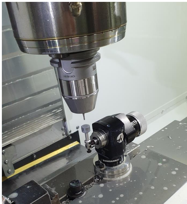
Slika 7.15. Sustav za automatsko umjeravanje alata
