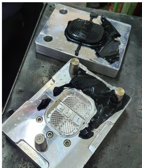
Slika 7.29. Otvaranje kalupa, nakon prešanja
