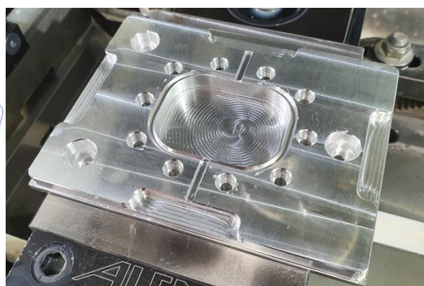
Slika 7.19. Proces izrade srednje ploče kalupa: a) stezanje 1, faza a, b) stezanje 1, faza b
