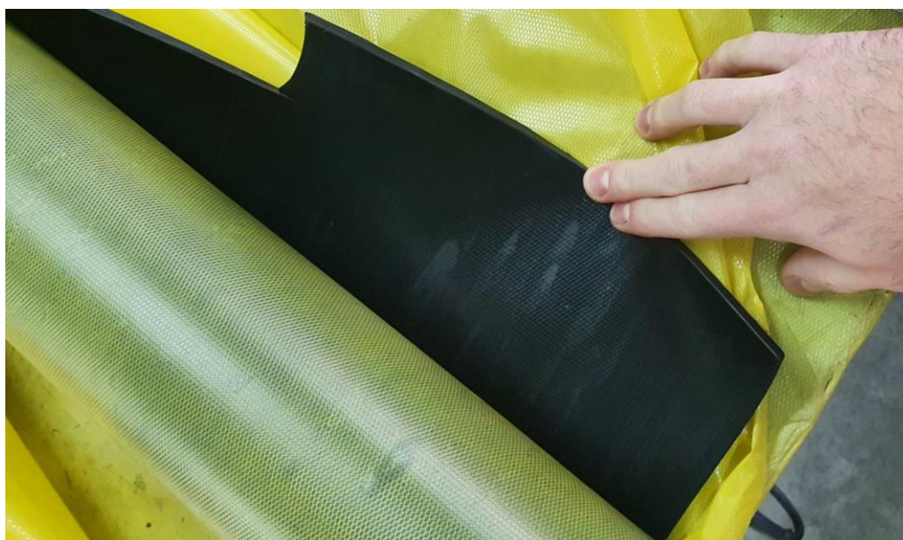
Slika 7.27. Kalandrat EPDM-a debljine 4 mm
