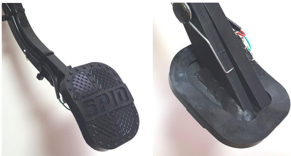
Slika 7.33. Izrađena gumena zaštita pedale
