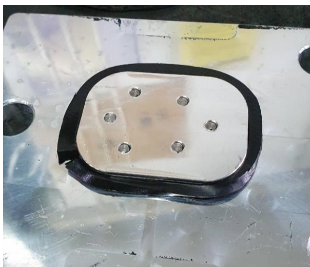
Slika 7.31. Punjenje kalupne šupljine EPDM-om - varijanta 2
