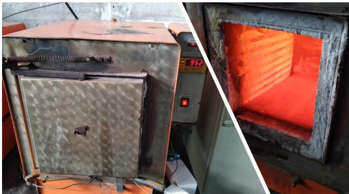
Slika 19. Prikazuje peć prethodno ugrijanu na temperaturu boriranja
