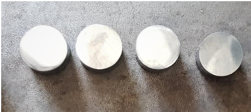
Slika 17. Odmašćeni i izbrušeni uzorci spremni za boriranje
