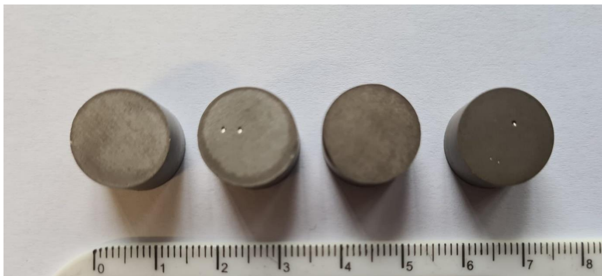
Slika 21. Uzorci nakon boriranja i dubokog boriranja
