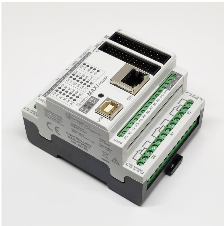
Slika 34. Upravljački uređaj Controllino Maxi Power Automation [11]
