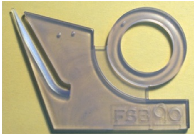
Slika 3.4 Otpresak sa podtlačni mjehurićima
