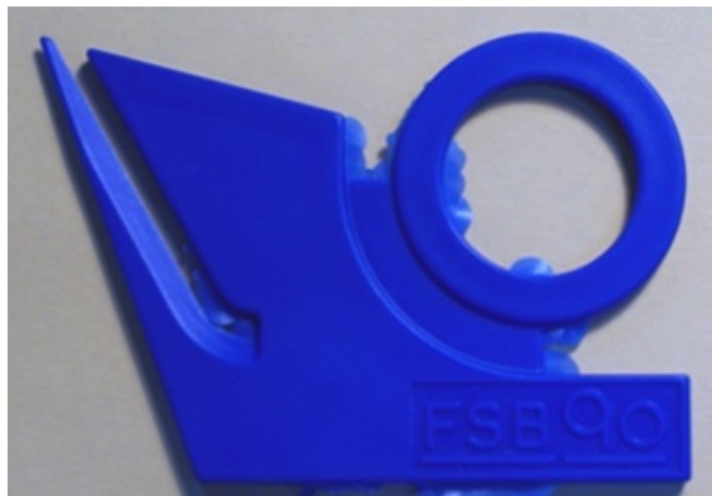
Slika 3.1 Otpresak sa srhom
