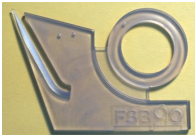
Slika 3.4 Otpresak sa podtlačni mjehurićima
