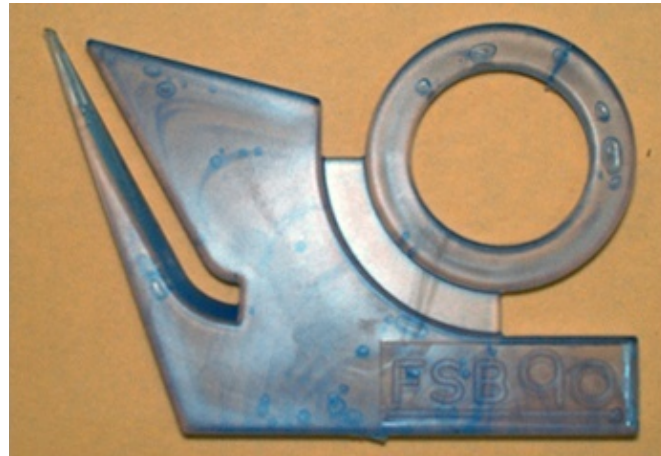
Slika 3.5 Otpresak sa mjehurićima zraka
