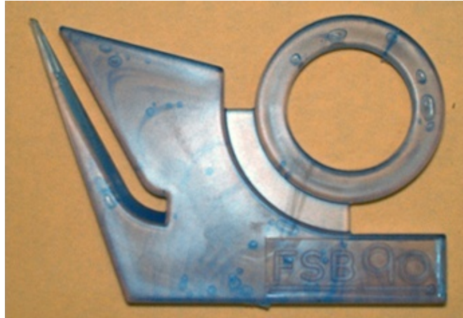
Slika 3.5 Otpresak sa mjehurićima zraka
