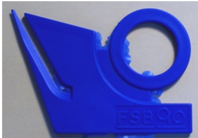
Slika 3.1 Otpresak sa srhom
