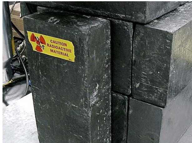
Slika 6.7 Olovna zaštita od zračenja [13]
