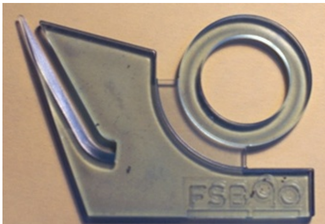
Slika 3.6 Otpresak sa uključenim česticama metala
