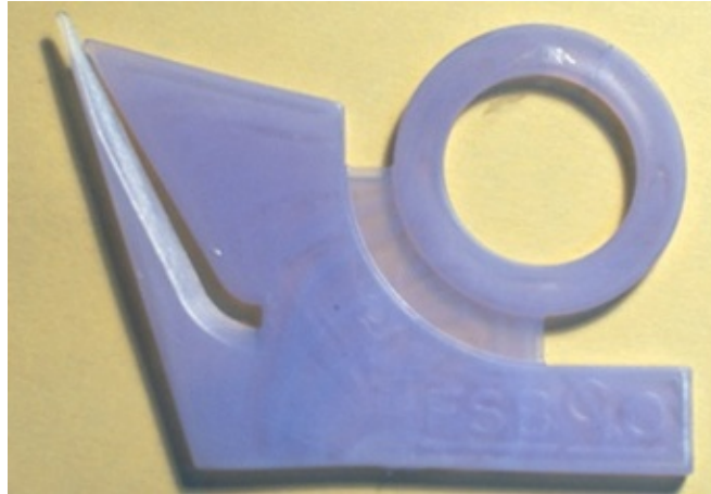
Slika 3.7 Otpresak sa pukotinom
