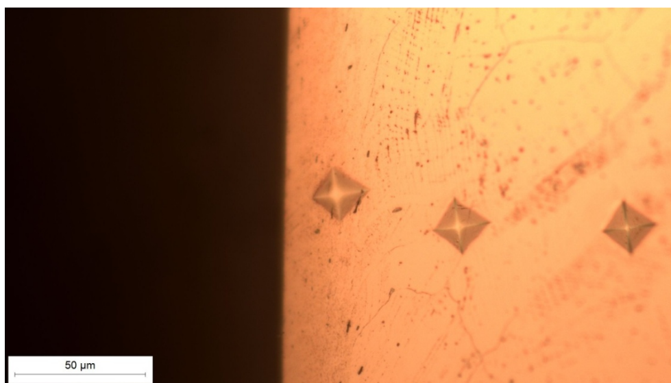
Slika 41. Rubni sloj uzorka od austenitnog nehrđajućeg čelika nitriranog na 500 °C 14 sati
