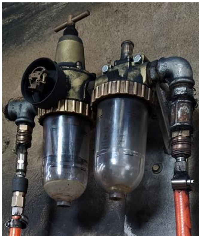
Slika 30. Priprema za odvajanje vlage iz zraka
