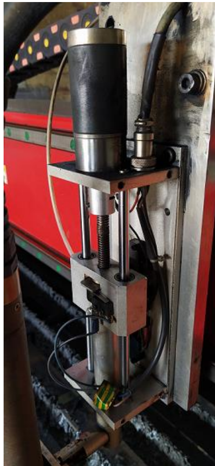
Slika 27. Vertikalni podizač CNC plazma stoja bez zaštitne limene maske
