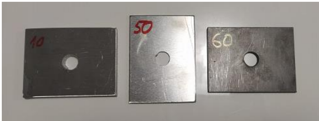
Slika 36. Izrezani i obrušeni ispitni uzorci
