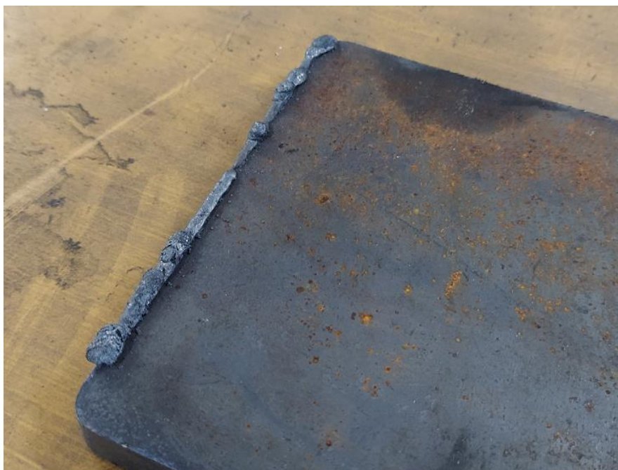
Slika 9. Akumulacija troske s donje strane izrezanog komada uslijed premale brzine
