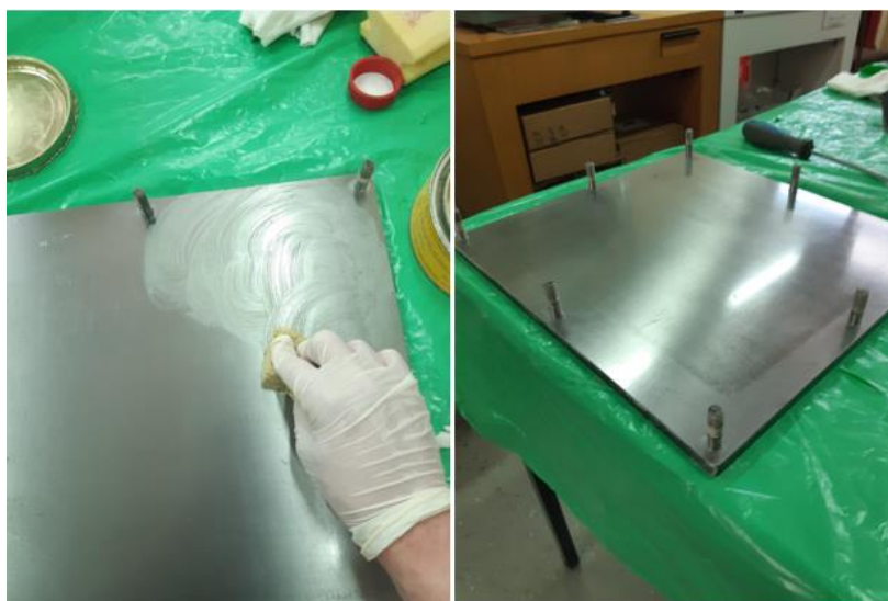
Slika 5.2. Nanošenje odvajala i poliranje kalupa
