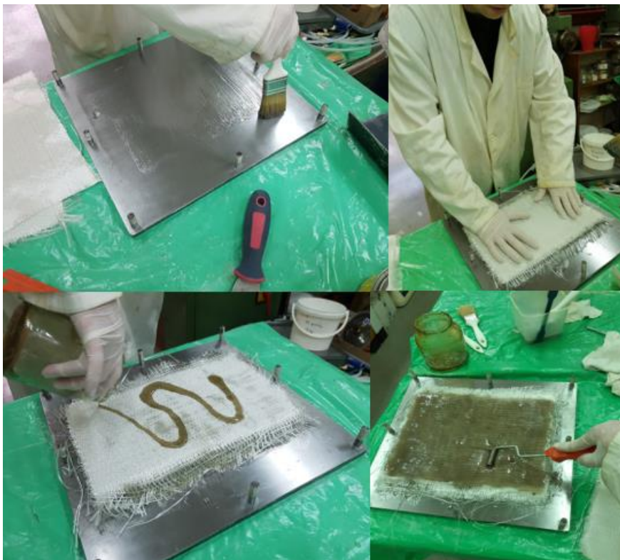
Slika 5.4. Postupak izrade ploče
