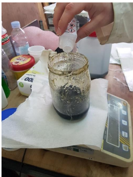
Slika 5.3. Vaganje smole i katalizatora i miješanje
