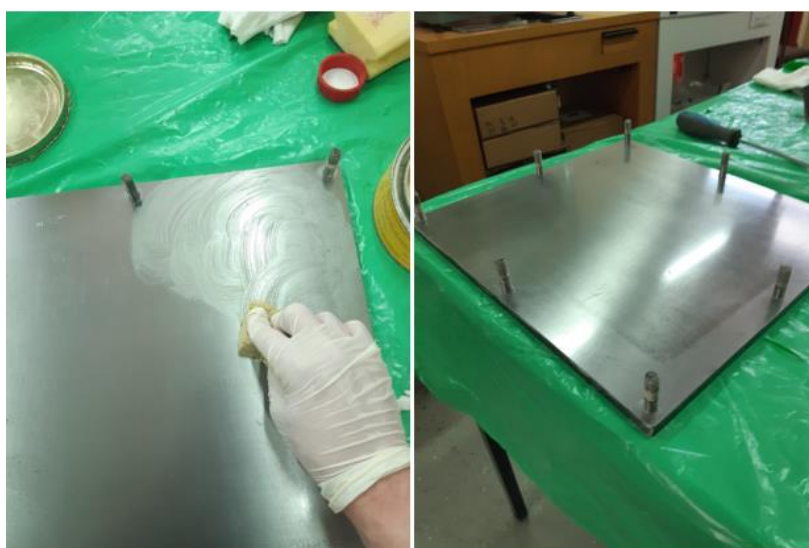
Slika 5.2. Nanošenje odvajala i poliranje kalupa
