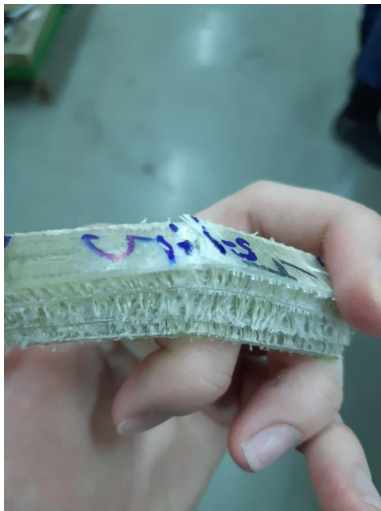
Slika 5.18. Ispitni tijelo Ž-5-3 nakon ispitivanja žilavosti
