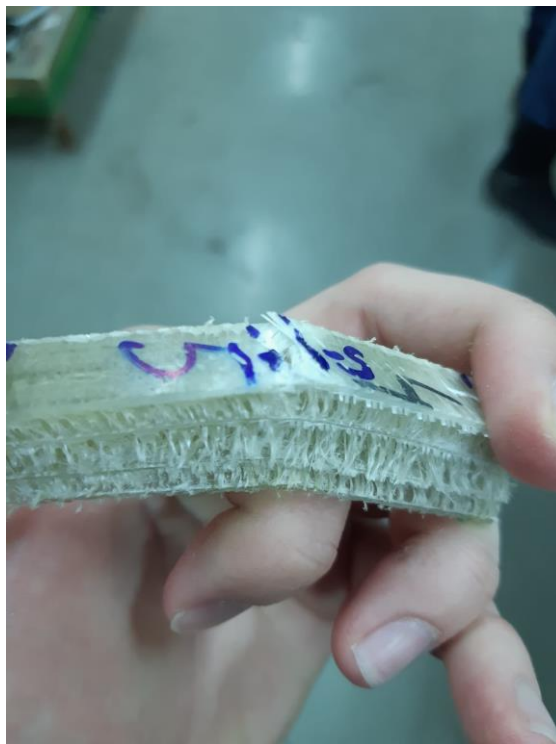
Slika 5.18. Ispitni tijelo Ž-5-3 nakon ispitivanja žilavosti
