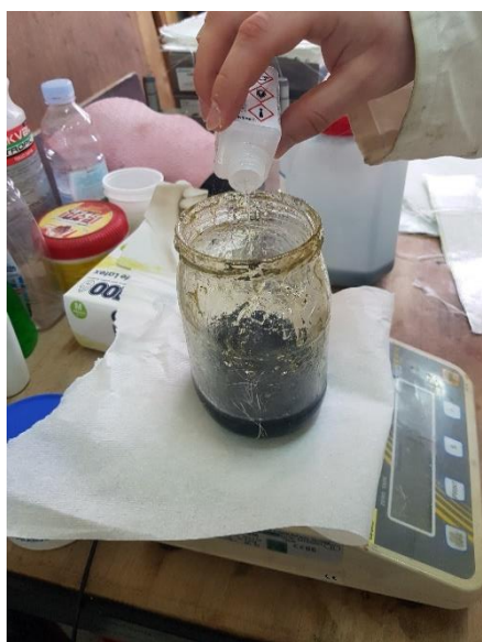
Slika 5.3. Vaganje smole i katalizatora i miješanje
