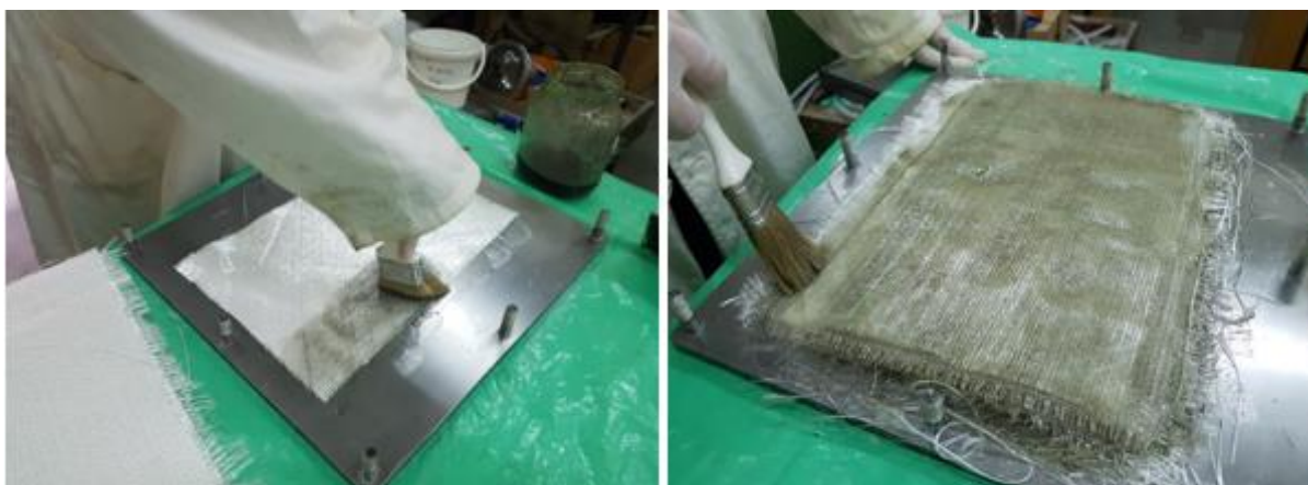
Slika 5.6. Natapanje sloja tkanine odnosno mata smolom i istiskivanje zraka
