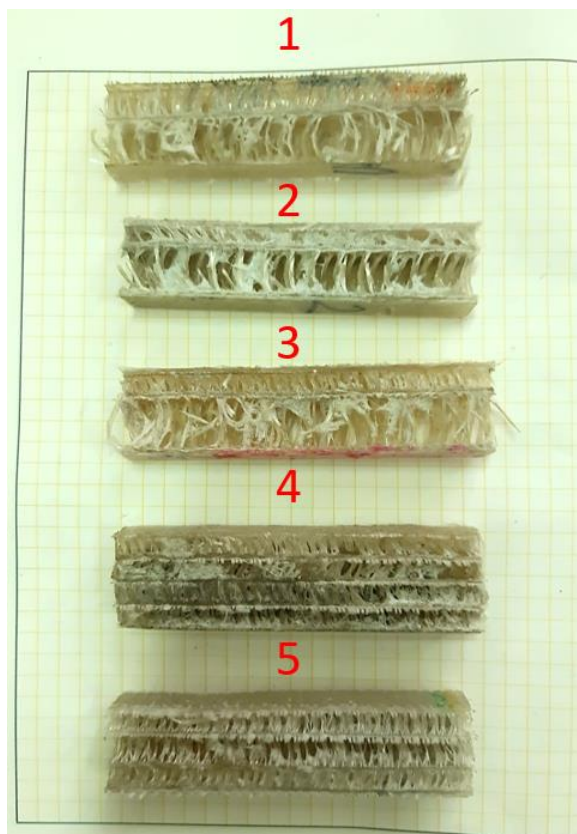
Slika 5.1. Struktura izrađenih ploča
