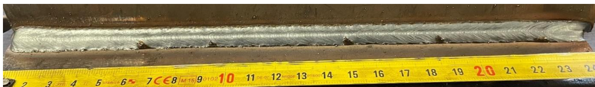
Slika 32. Izgled zavora uzorka 5
