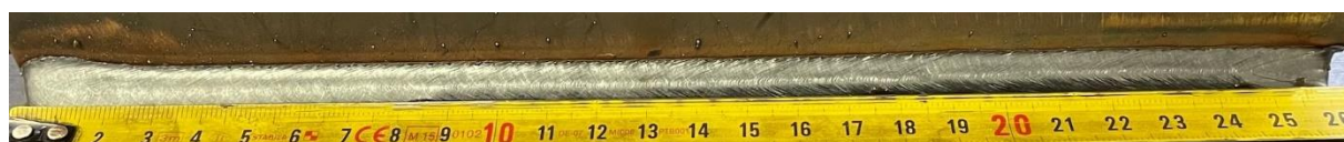
Slika 28. Izgled zavara uzorka 1
