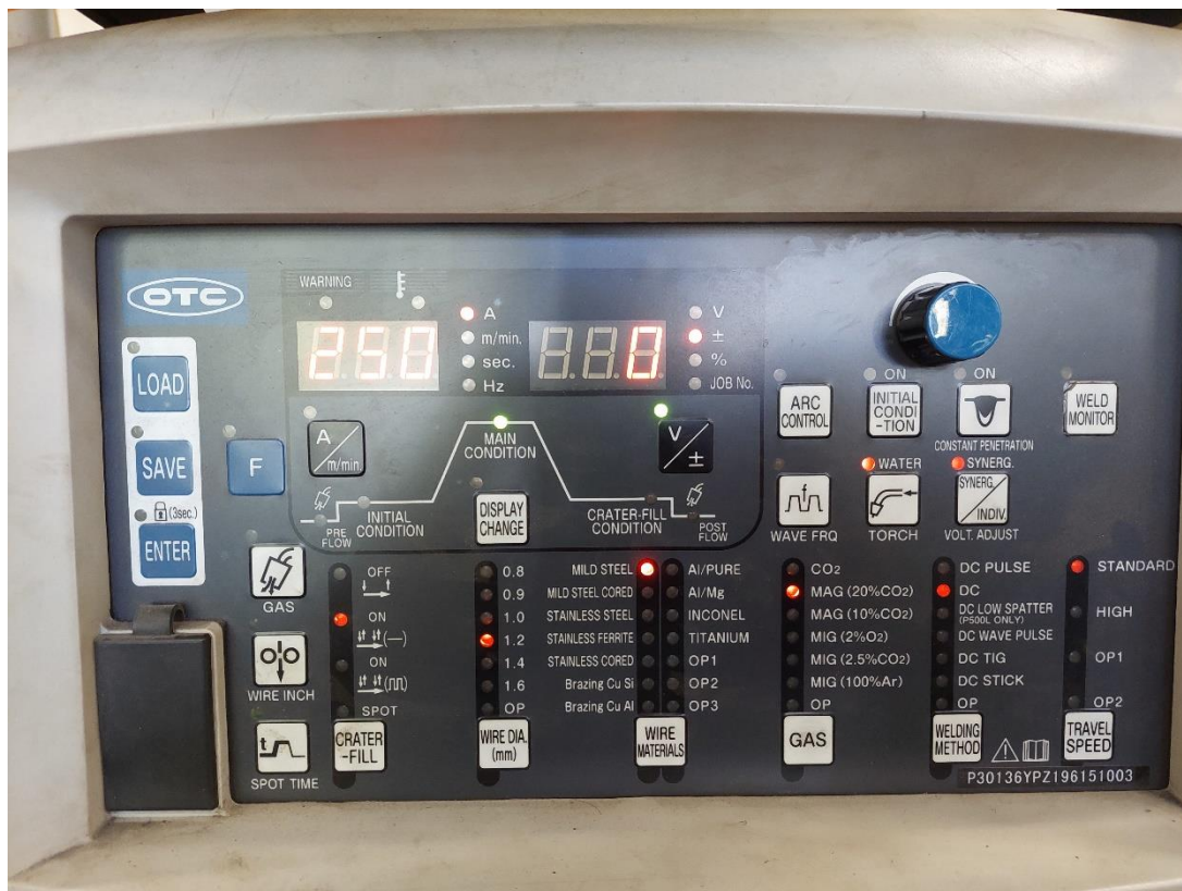
Slika 24. Korisničko sučelje uređaja Daihen Varstroj WB – 400
