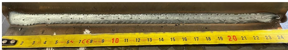
Slika 31. Izgled zavara uzorka 4
