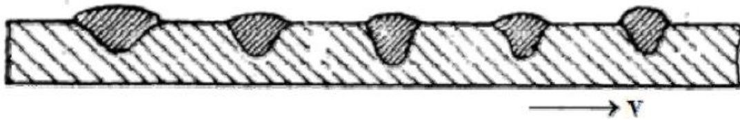
Slika 16. Utjecaj brzine zavarivanja na geometriju zavara [14]
