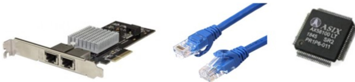
Slika 4-3. Mrežna kartica (lijevo), Cat5 kabel s RJ45 konektorom (sredina) i ESC čip (desno)
