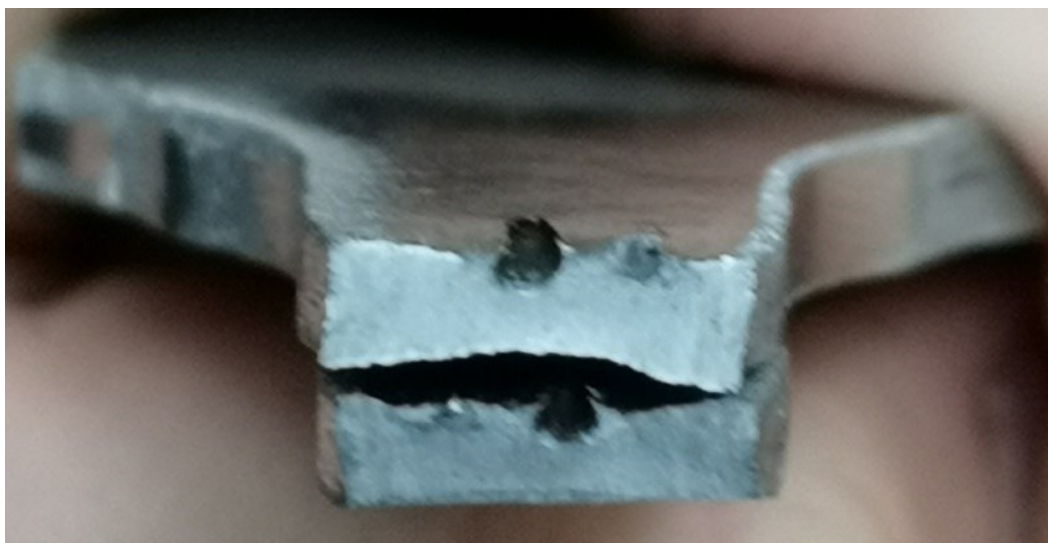
Slika 64. Navarivanje na mjestu prijeloma (H2)
