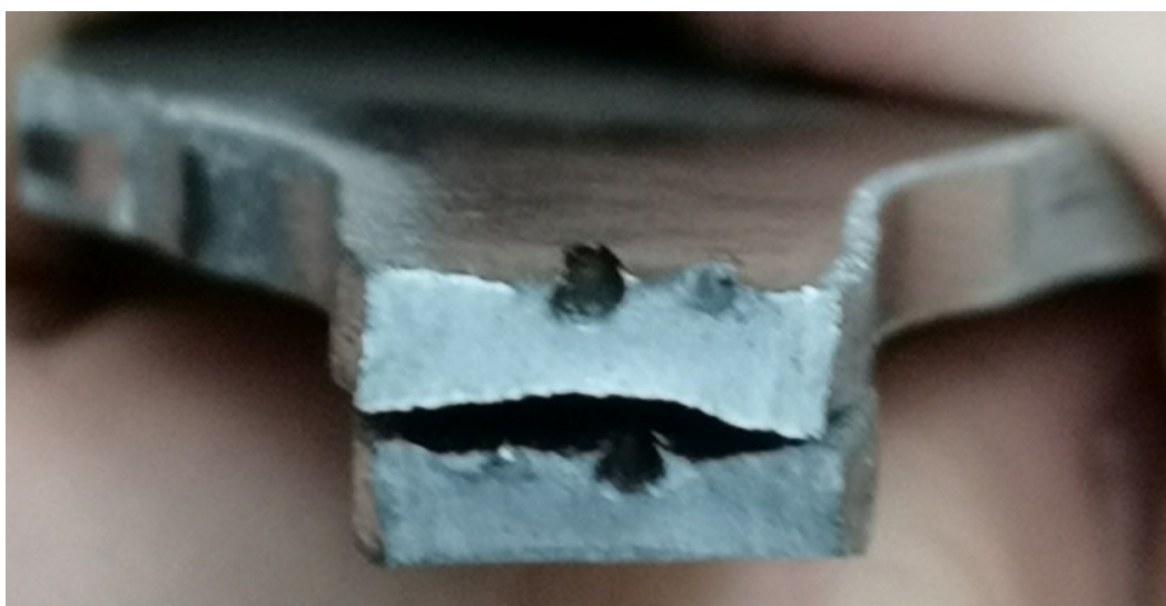
Slika 64. Navarivanje na mjestu prijeloma (H2)
