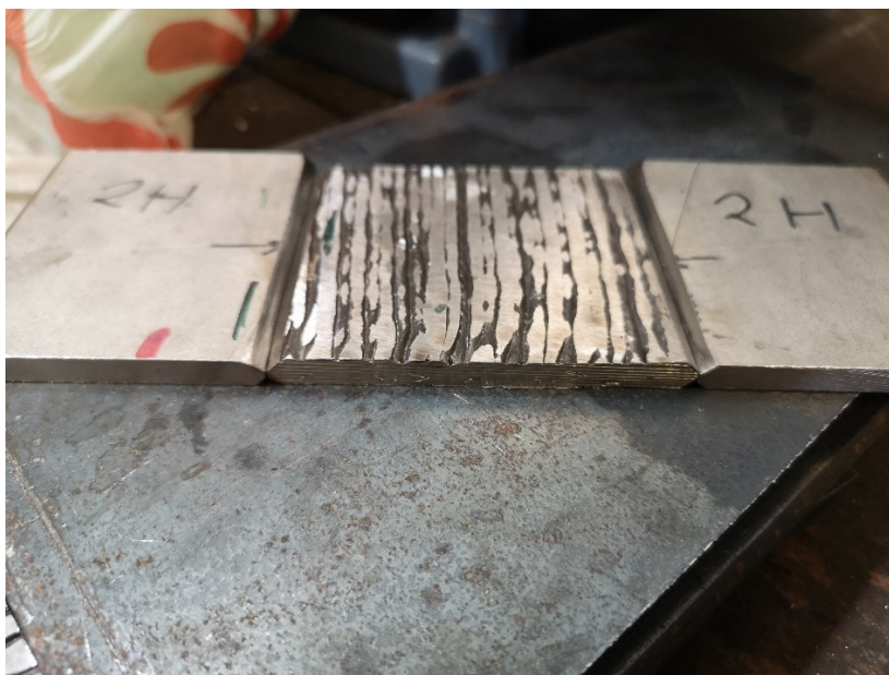
Slika 50. Priprema za navarivanje dodatka u smjeru izrade (2V)
