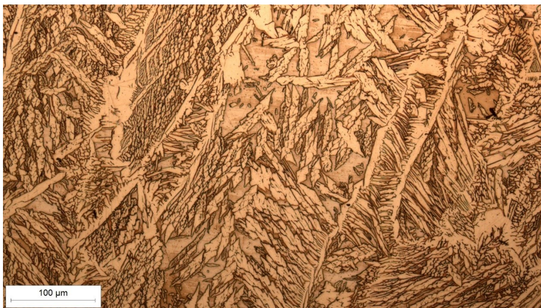
Slika 84. Originalna slika korištena za izračun udjela ferita, povećanje 200x (B3)
