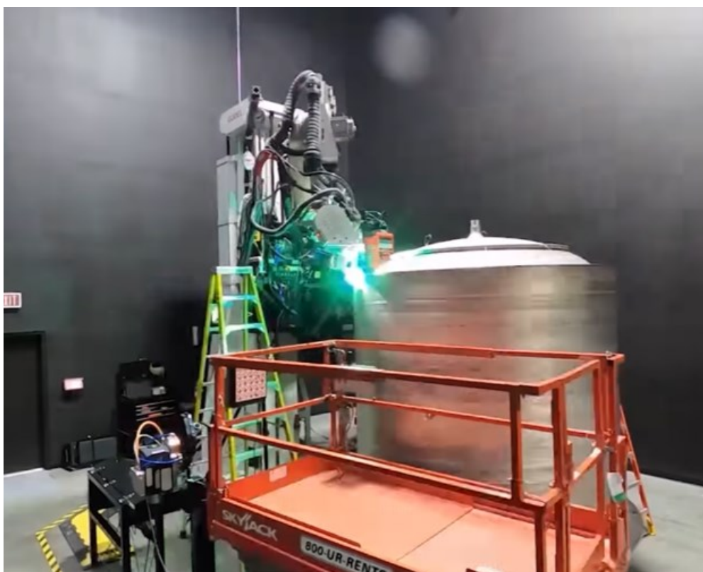
Slika 4. Izrada TerranR rakete WAAM postupkom AM [9]
