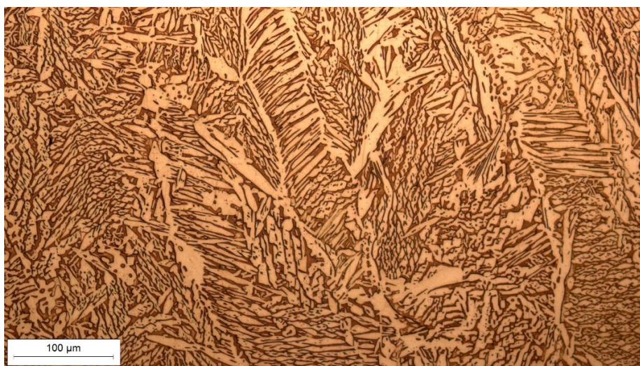
Slika 80. Mikrostruktura prije homogenizacijskog žarenja, povećanje 200x
