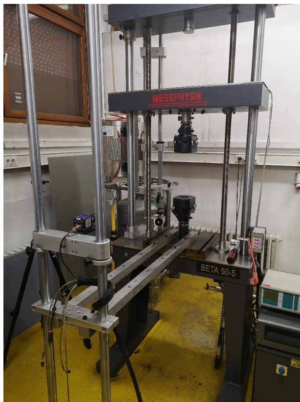
Slika 62. Kidalica MESSPHYSIK BETA 50-5 sa optičkim ekstenziometrom
