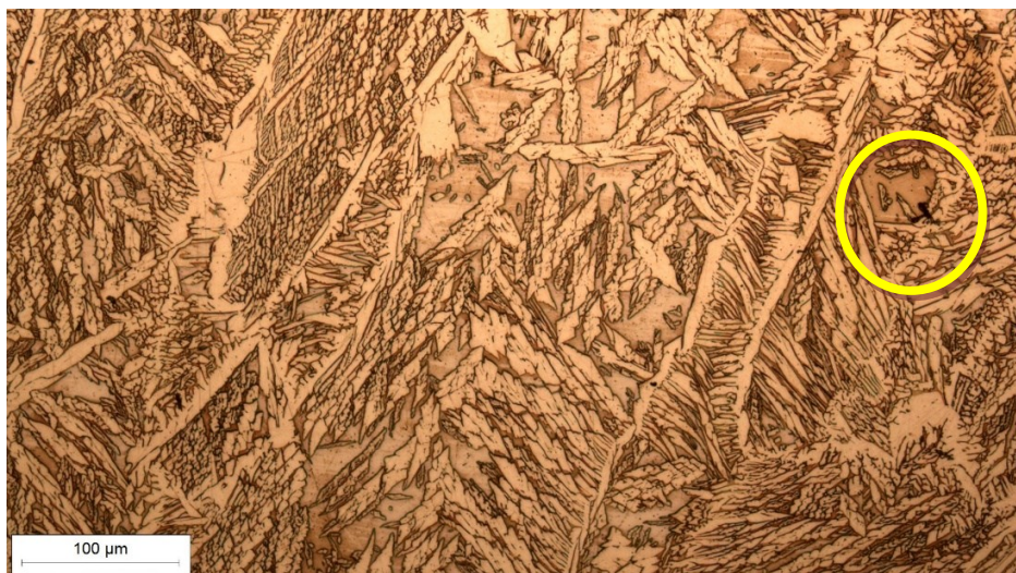
Slika 80. Mikrostruktura prije homogenizacijskog žarenja, povećanje 200x
