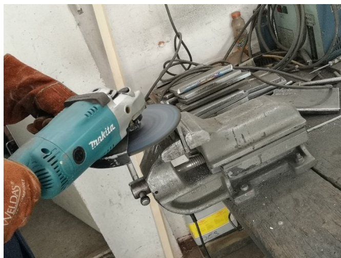
Slika 48. Priprema zida za zavarivanje
