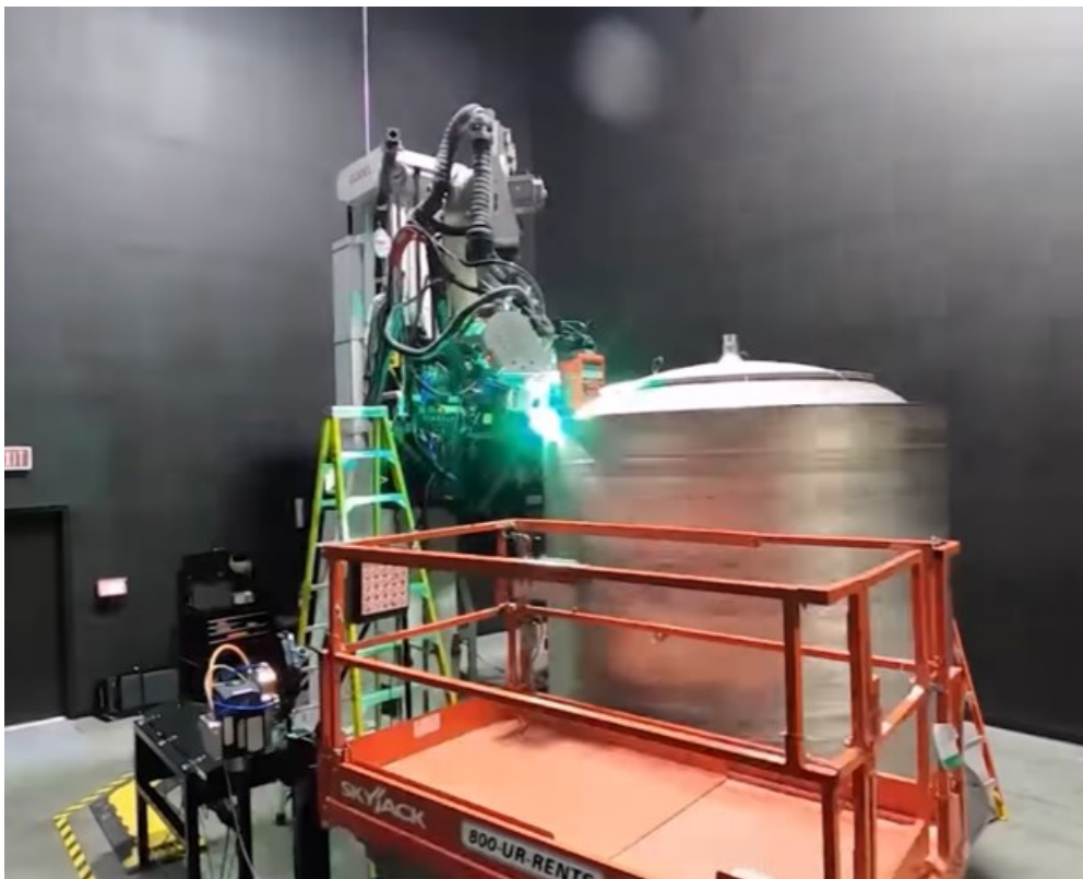
Slika 4. Izrada TerranR rakete WAAM postupkom AM [9]
