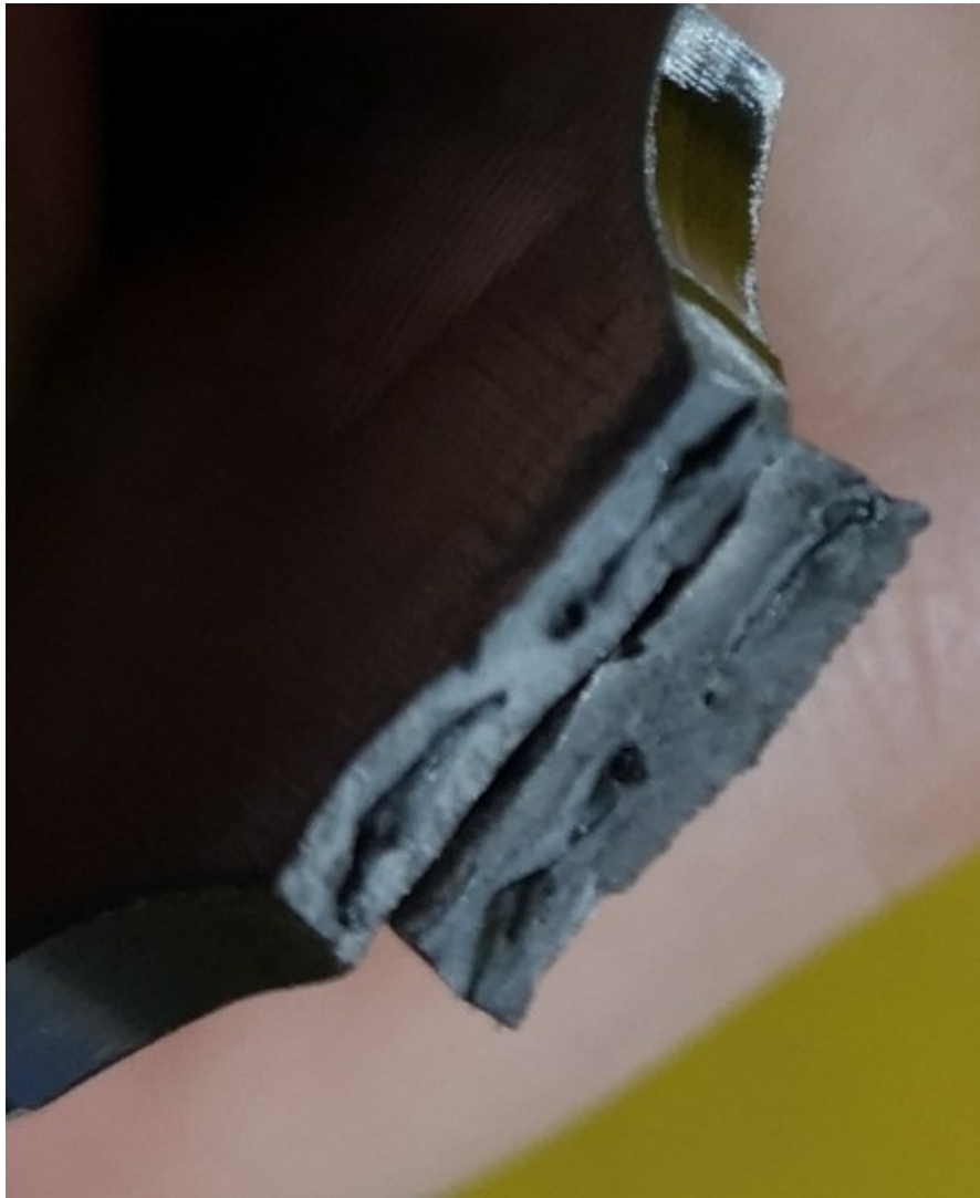
Slika 64. Navarivanje na mjestu prijeloma (H2)
