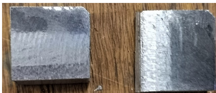
Slika 36. Razrezan uzorak za mjerenje kemijskog sastava
