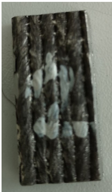
Slika 31. Uzorak na kojem je obavljano mjerenje kemijskog sastava
