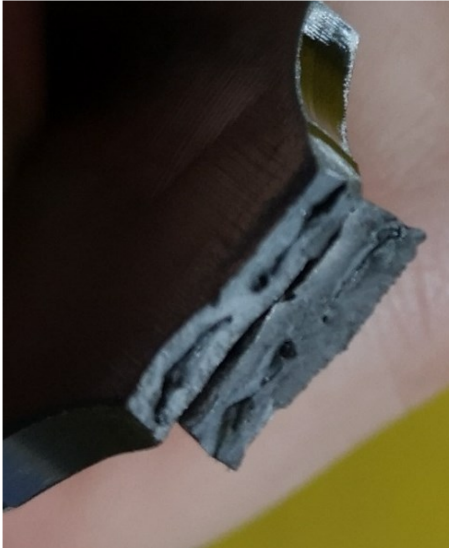
Slika 64. Navarivanje na mjestu prijeloma (H2)
