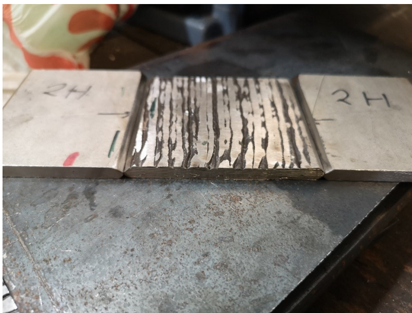
Slika 50. Priprema za navarivanje dodatka u smjeru izrade (2V)
