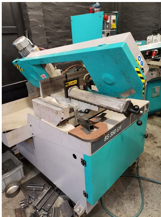
Slika 27. Tračna pila korištena za rezanje zida
