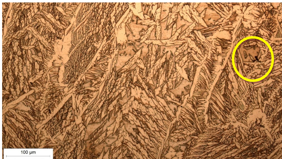
Slika 80. Mikrostruktura prije homogenizacijskog žarenja, povećanje 200x
