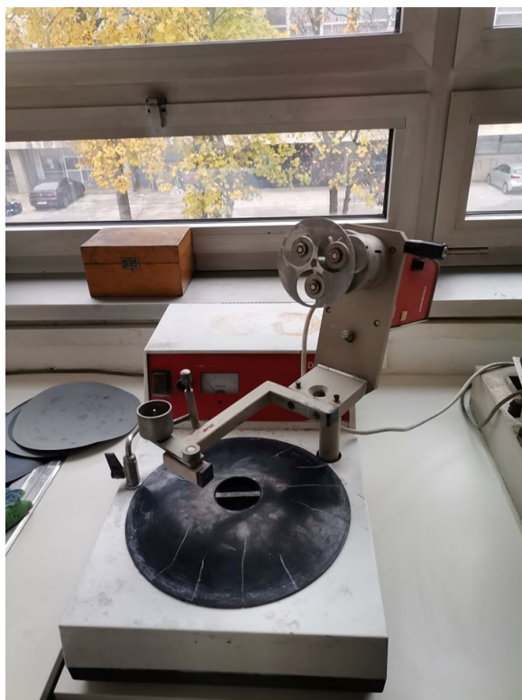
Slika 39. Uređaj za fino poliranje uzoraka
