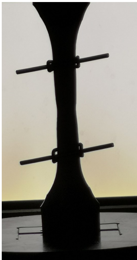
Slika 66. Vidljivo nastajanje vrata na epruveti
