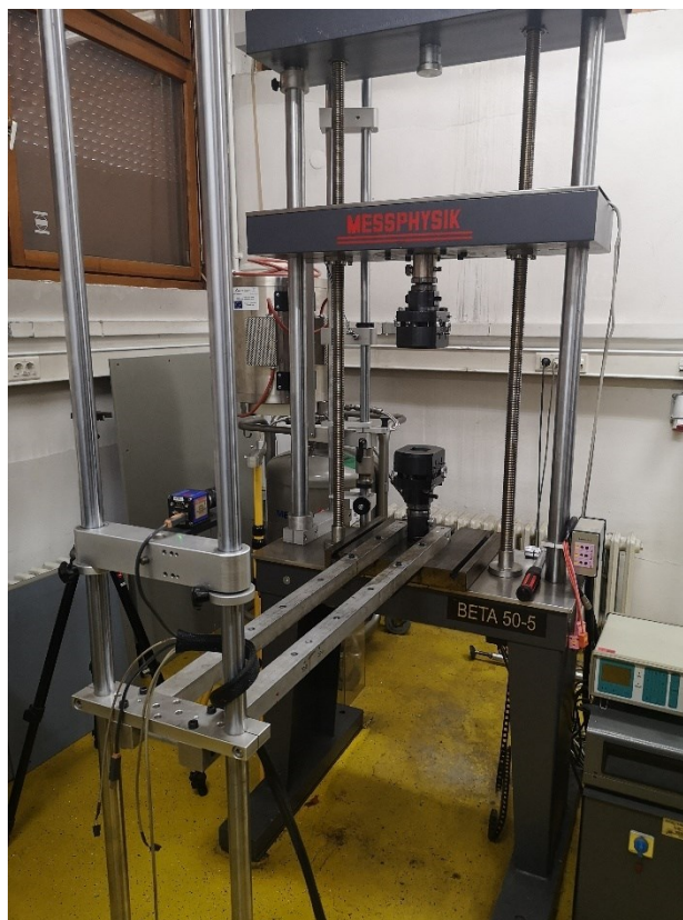
Slika 62. Kidalica MESSPHYSIK BETA 50-5 sa optičkim ekstenziometrom
