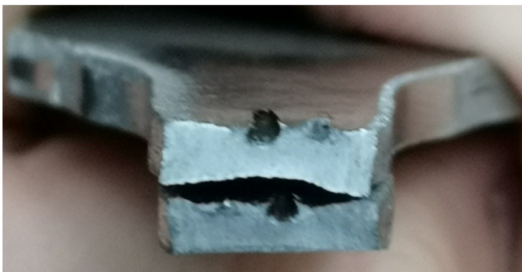
Slika 64. Navarivanje na mjestu prijeloma (H2)
