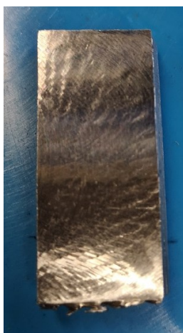
Slika 33. Uzorak za analizu kemijskog sastava nakon skidanja sloja materijala
