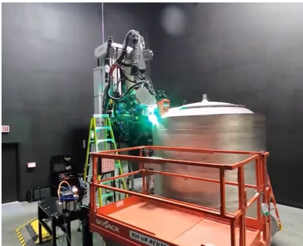
Slika 4. Izrada TerranR rakete WAAM postupkom AM [9]
