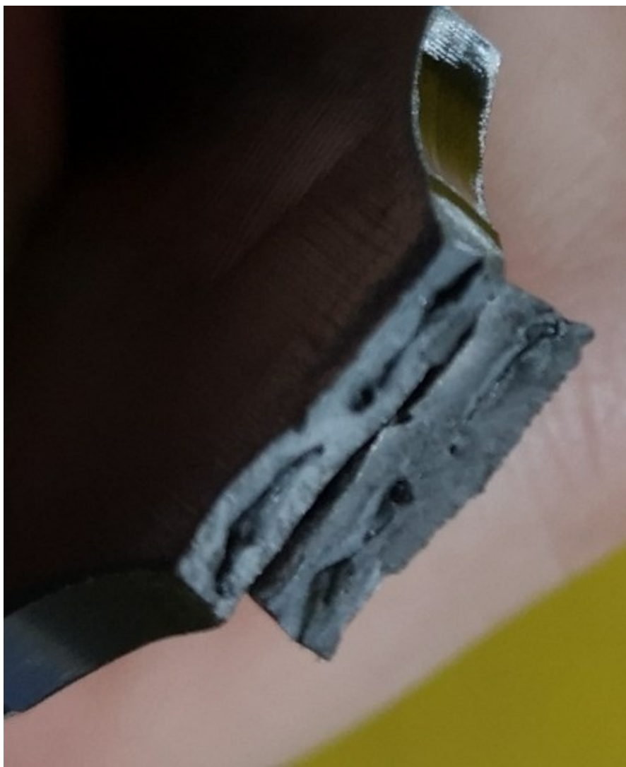
Slika 64. Navarivanje na mjestu prijeloma (H2)
