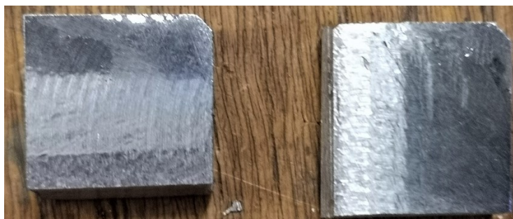
Slika 36. Razrezan uzorak za mjerenje kemijskog sastava
