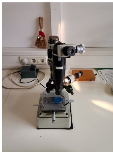
Slika 42. Mikrotvrdomer PMT-3 korišten u eksperimentu
