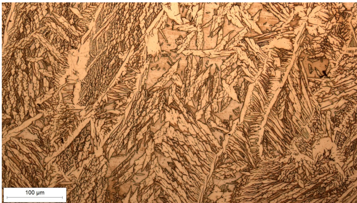
Slika 47. Jasno vidljiva granica austenita i ferita, povećanje 200x (B3)
