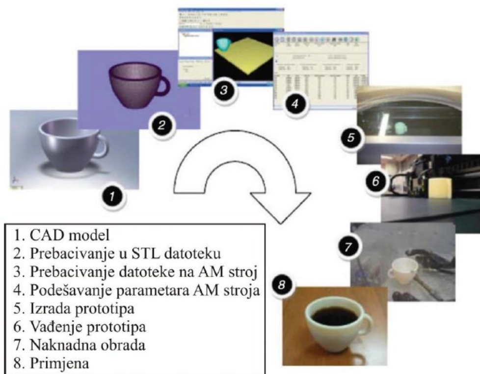
Slika 2. Faze aditivne proizvodnje [4]
