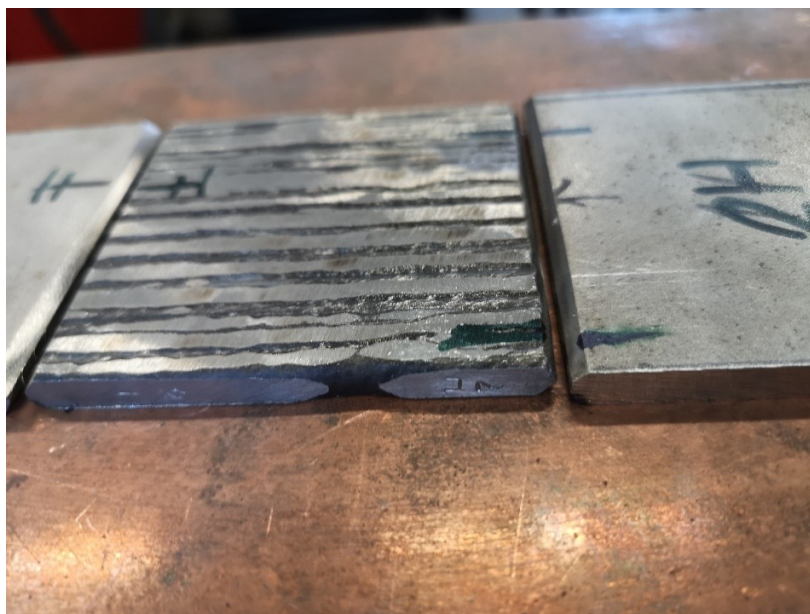
Slika 49. Priprema za navarivanje dodataka okomito na smjer izrade (2H)
