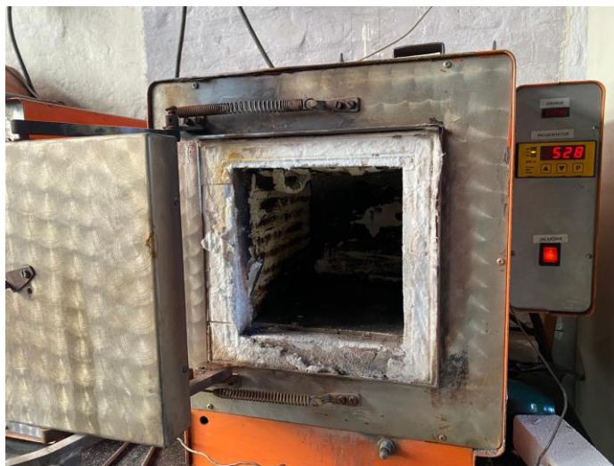
Slika 43. Peć za popuštanje čelika (525 °C; 180 °C)
