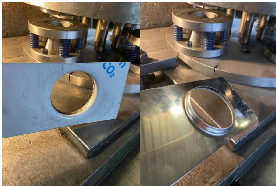
Slika 49. Izgled lima nakon probijanja izrađenim alatom
