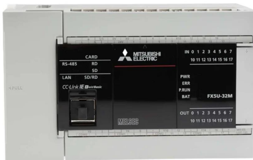
Slika 9. FX5U-32M programibilni logički kontroler [6]
