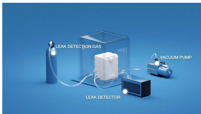
Slika 20. Postupak testiranja istjecanja helija [5]
