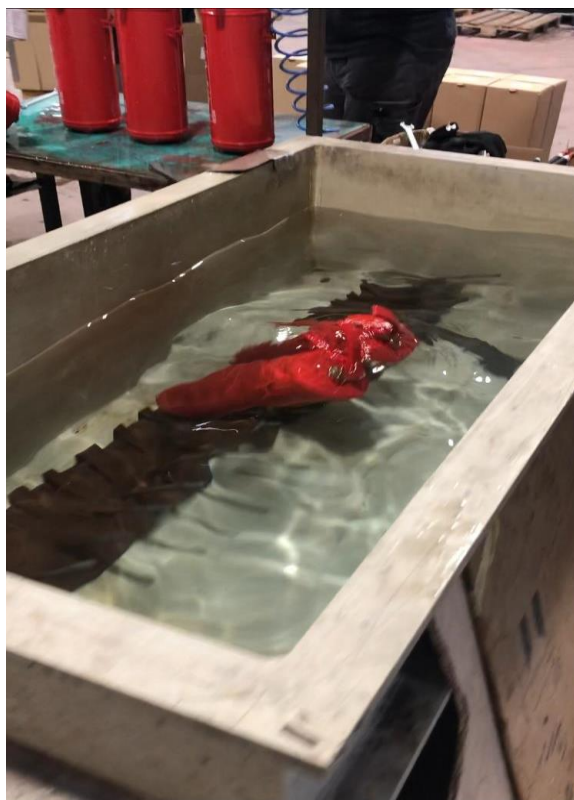
Slika 10. Testiranje aparata u vodi
