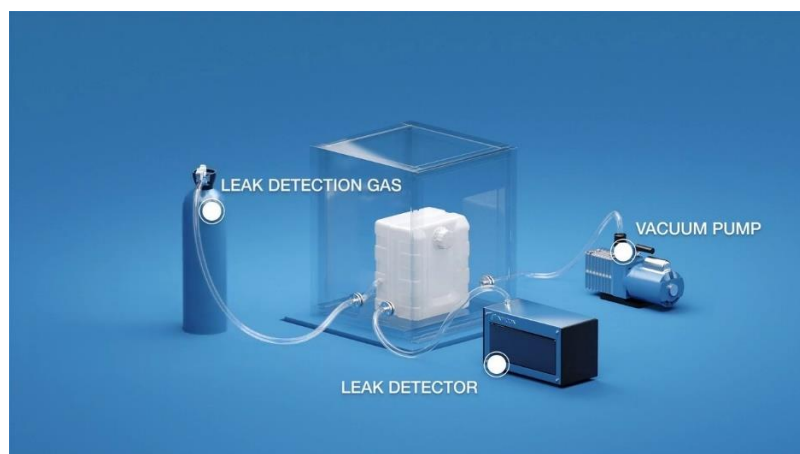
Slika 20. Postupak testiranja istjecanja helija [5]
