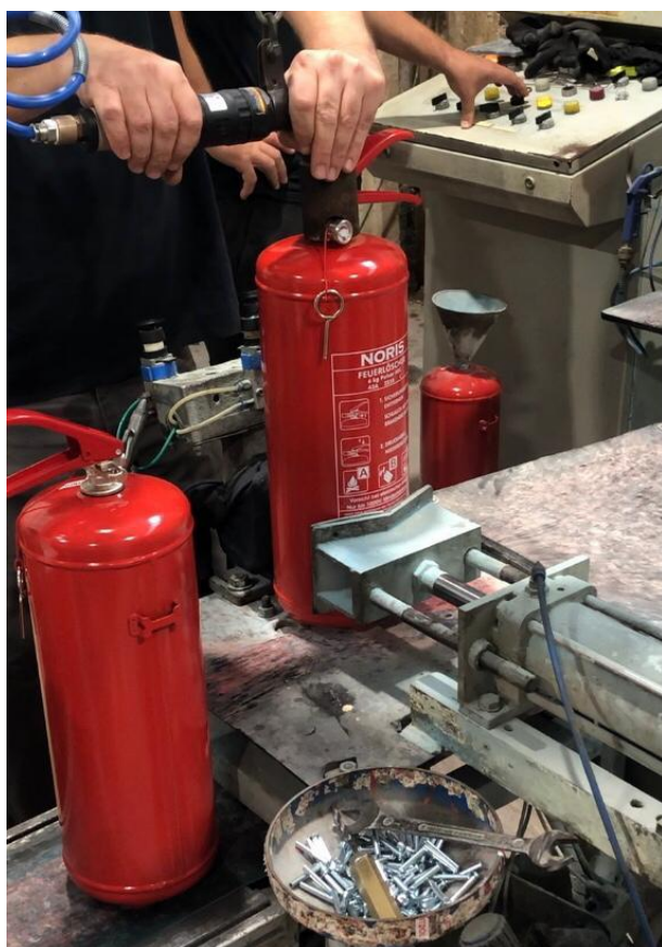
Slika 7. Stezanje ventila pneumatskim pištoljem
