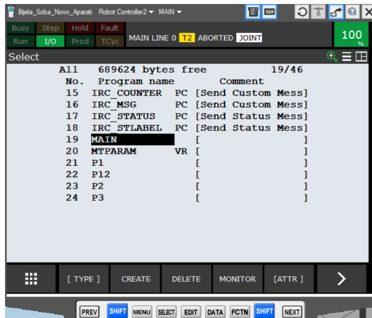
Slika 64. Kreiranje novog programa na TP
