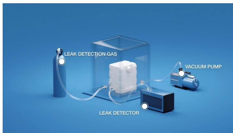
Slika 20. Postupak testiranja istjecanja helija [5]
