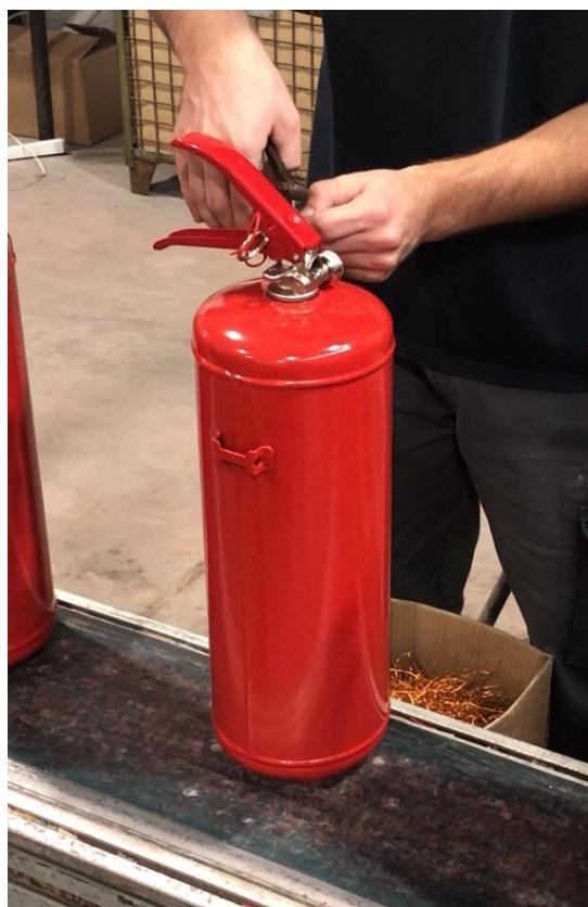
Slika 9. Stavljanje osigurača i plombe
