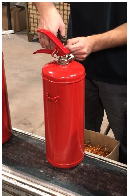
Slika 9. Stavljanje osigurača i plombe
