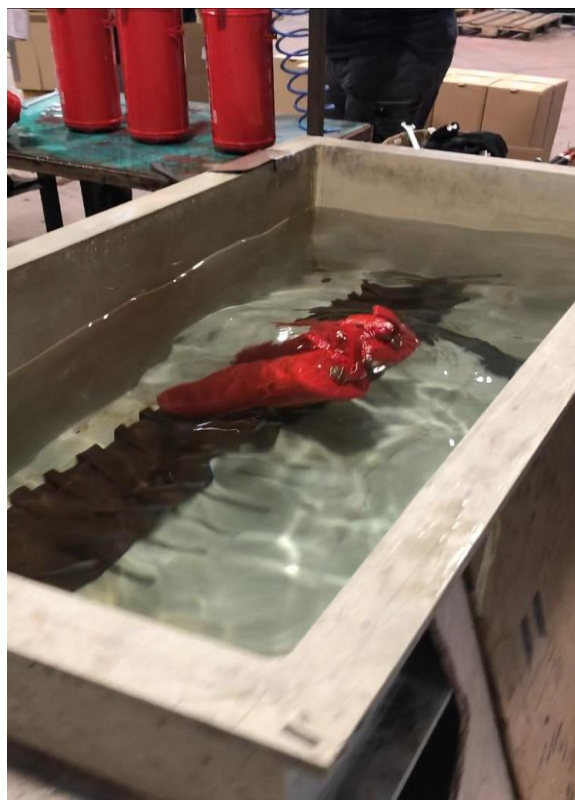
Slika 10. Testiranje aparata u vodi
