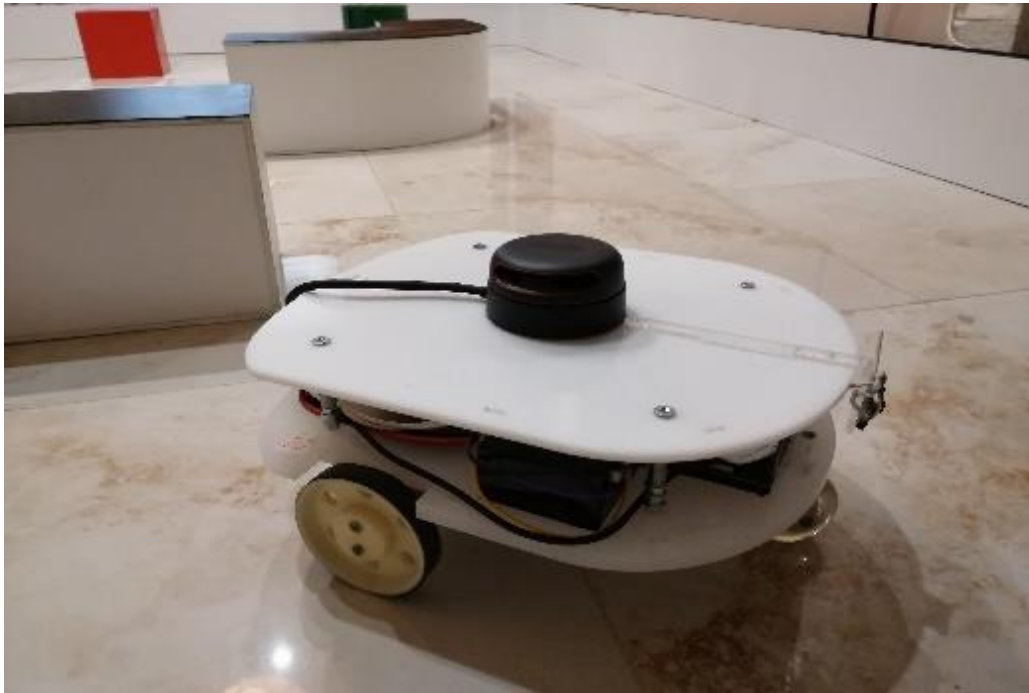
Slika 1. Mobilni roboti: (a) starija generacija opremljena IR senzorima daljine; (b) novija generacija opremljena laserskim senzorom daljine (LiDAR).
