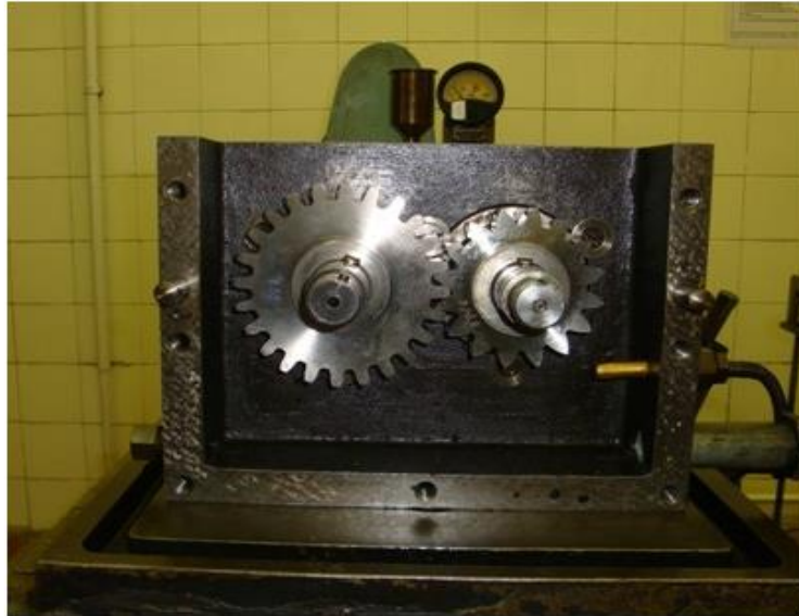
Slika 108: Zupčanički par u zahvatu [49]
