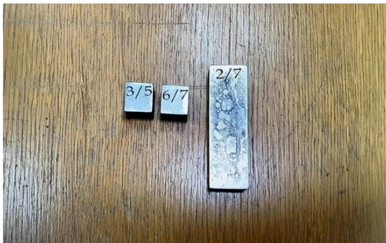
Slika 143: Uzorci na kojima je ispitana tvrdoća
