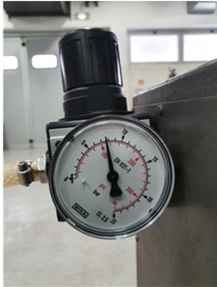
Slika 142: Manometar na ulazu u napravu za kugličarenje
