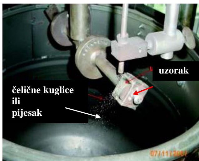
Slika 99: Izgled unutrašnjosti uređaja za ispitivanje otpornosti na eroziju
