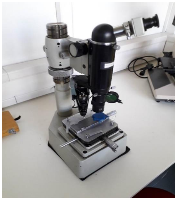
Slika 145: Mikro tvrdomjer PMT-2
