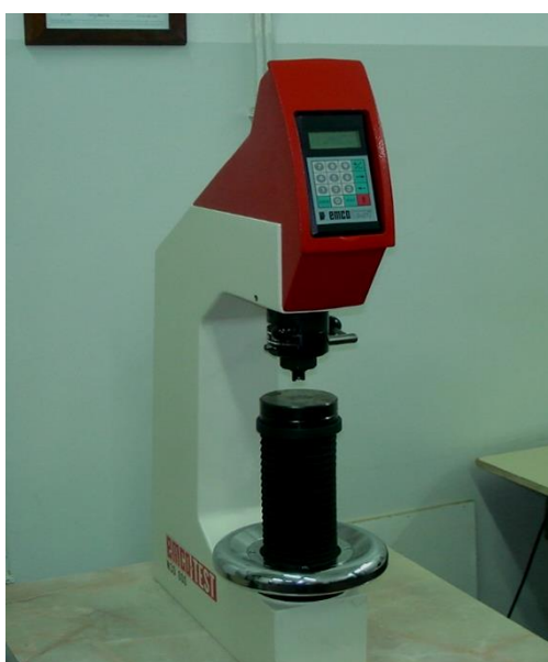
Slika 66: Tvrdomjer Emco-Test N3D 000
