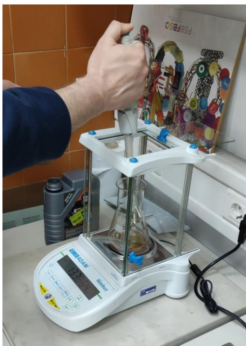
Slika 1. Odvaga potrebne količine mazivog ulja
